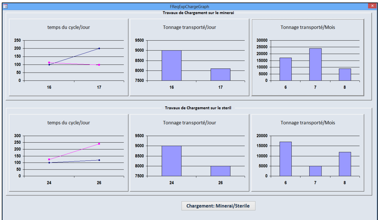
Figure VIII.31: Formulaire montrant les graphes de la variation du temps du cycle et de tonnage chargé/jour et mois (stérile et minéral)
