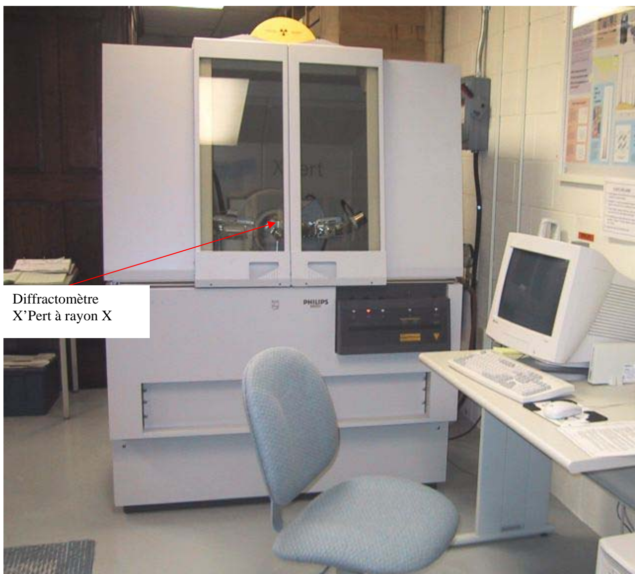
Fig. III.14 : Vue d'une installation de diffraction avec les rayons X
