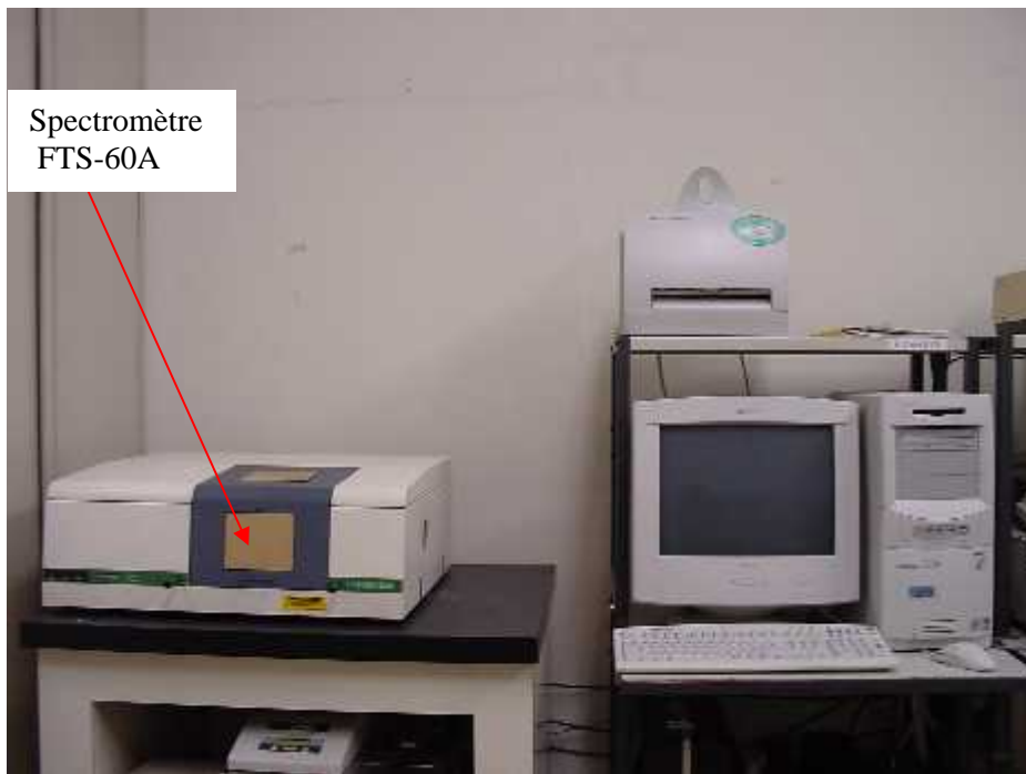
Fig. III.13 : Vue des différents éléments de mesure lors d'un essai FTIR.
