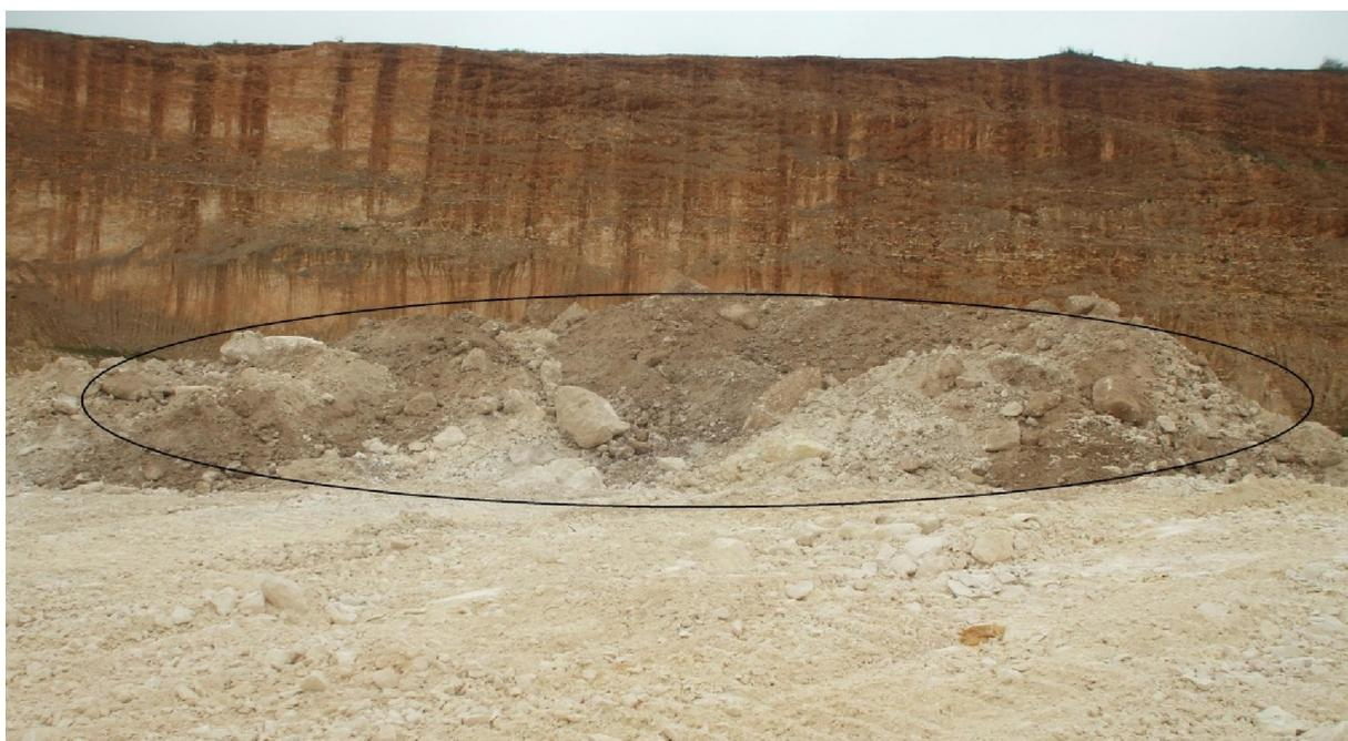
**Figure. III- 4:** Tas de stérile sur la plate forme de travail.
