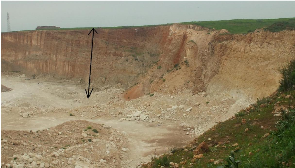
**Figure. III- 2 :** Gradin de l'exploitation de la carrière de Béni-saf.
