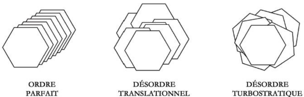
Figure 1.6 : Schéma des désordres possibles au sein de la structure des argiles lamellaires.
