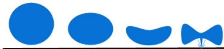
**Figure I-12 :** Évolution d'une bulle de cavitation à proximité d'une surface solide (Kim *et al.*, 2010).
