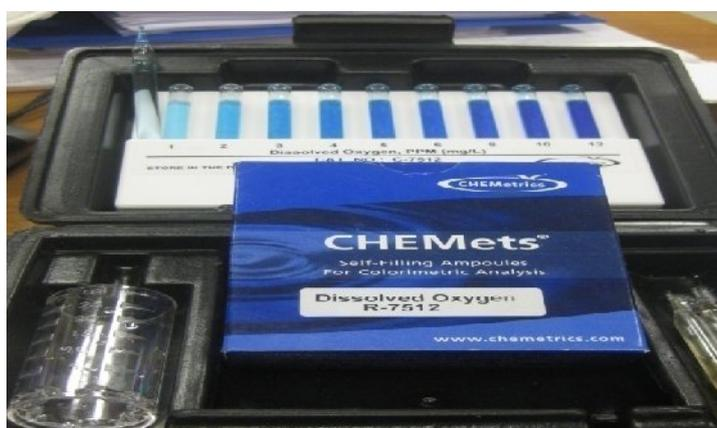
*Figure V.11 : Dispositif de mesure de la concentration de l'oxygène dissout.*
