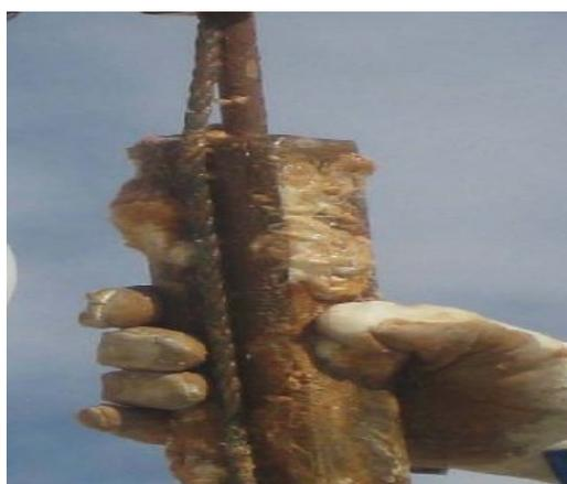
*Figure V.4. Anode réactive.*
