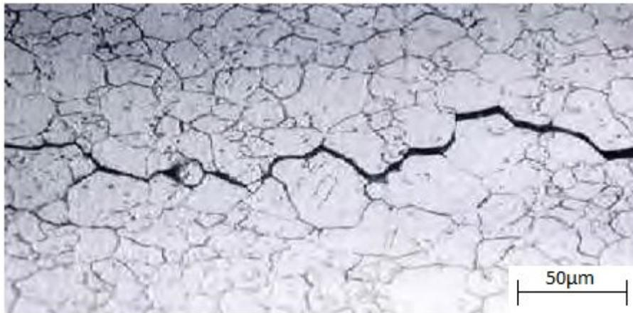
*Figure I.4 : Corrosion intergranulaire [3].*
