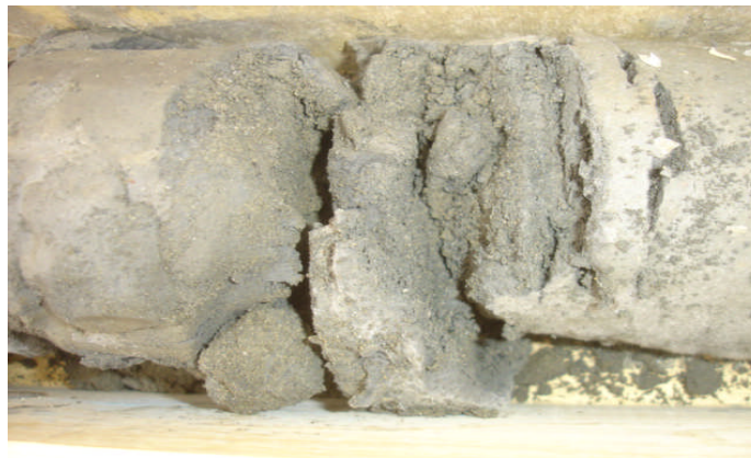
Figure. I. 4. Faciès de transit, Marne sableuse, bleuâtre-grisâtre dans un sondage, (Métro d'Alger, 2007).
