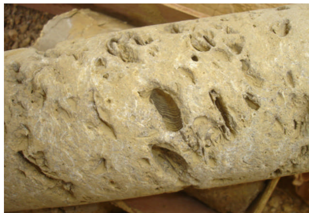
Figure. I. 6. Carotte de grès fossilifère astien dans un sondage à El Harrach, (Métro d'Alger, 2007).
