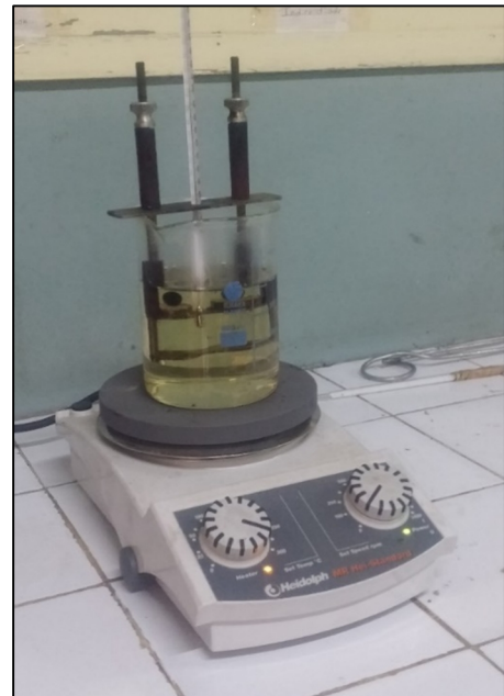
Figure IV.10 : Dispositif de la méthode bille et anneau.
