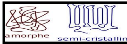
Figure I-5 : Structure amorphe et semi-cristalline
