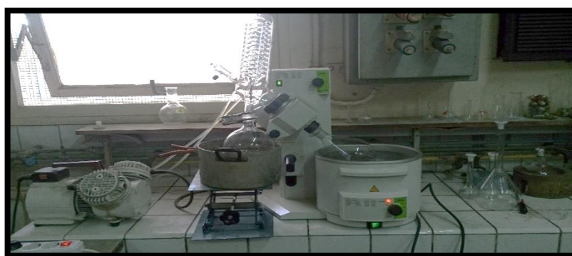
Figure II-25 : Montage de distillation sous vide au rotavapeur
