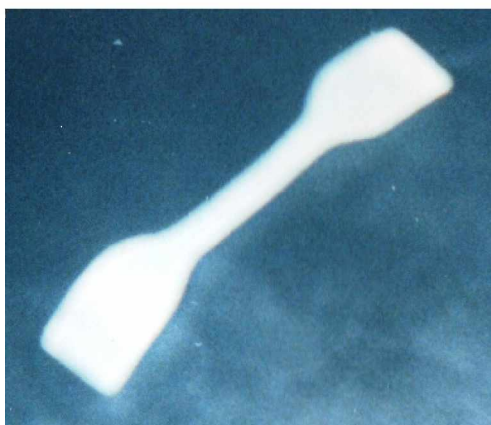
Figure IV.9 : Eprouvette en forme d'haltère [3]
