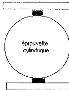
Figure IV. 2 : Essai de traction par fendage.
