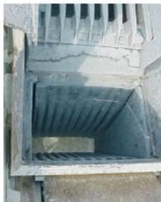
Fig. III.2 : ConcasEUR à mâchoires
