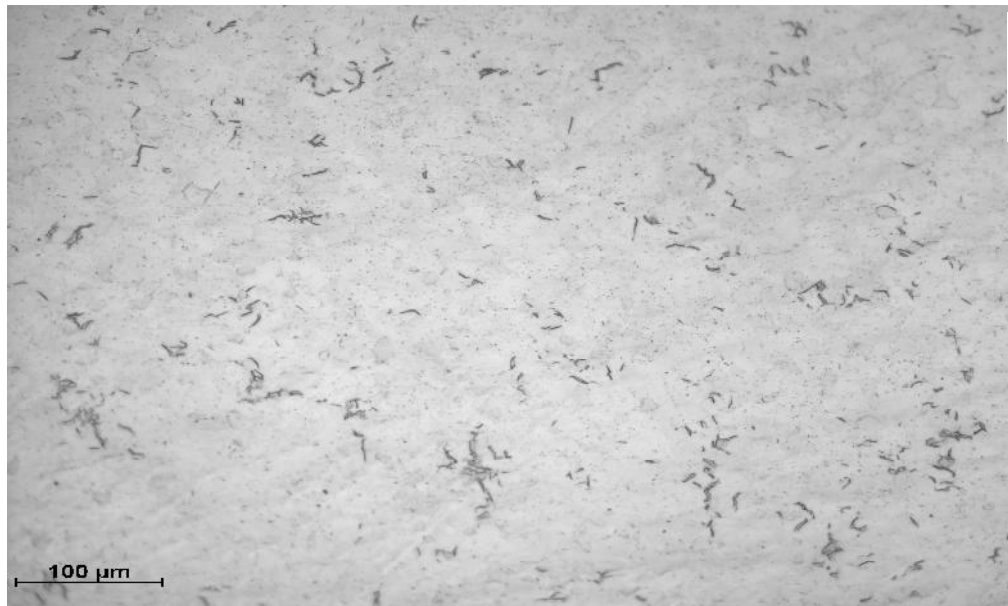
Figure V.20 : Surface hydrurée ( T=300\text{ °C} , V_{ref}=1\text{ °C/mn} ).
