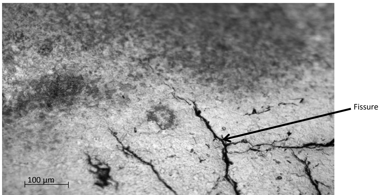
Figure V.22 : Fissuration d'un échantillon traité à T=400 °C et V_{ref}= 2 °C/mn (X200).
