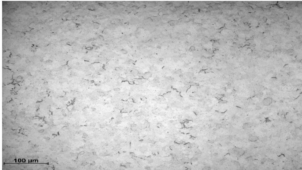
Figure V.12 : Surface hydrurée ( T=300 °C, V_{ref} = 15^{\circ}\text{C/mn} )
