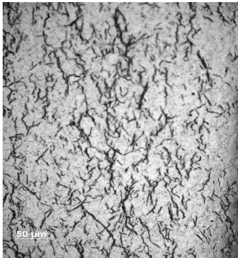
Figure V.8 : Epaisseur hydrurée ( T=400\text{ °C} , V_{ref}=2\text{ °C/mn} ).
