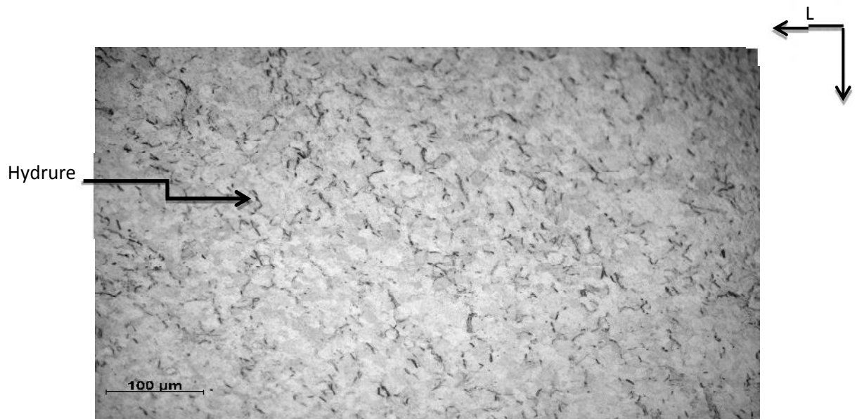
Figure V.1 : Surface hydrurée ( T=400\text{ °C} , V_{ref} = 15\text{°C/mn} ).
