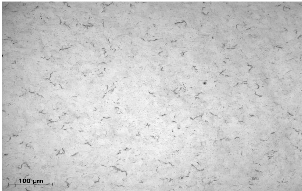
Figure V.14 : Surface hydrurée ( T=300\text{ }^{\circ}\text{C} , V_{ref} = 10^{\circ}\text{C/mn} ).
