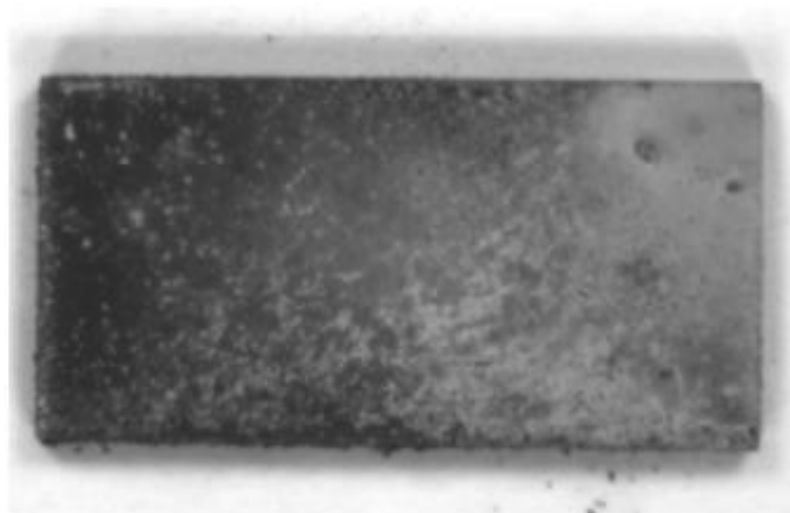
Figure IV.6 : Echantillon brulé pendant l'électrodéposition ( I > 11 \text{ mA} ).
