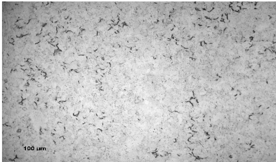
Figure V.3 : Surface hydrurée ( T=400\text{ °C} , V_{ref}=10\text{ °C/mn} ).
