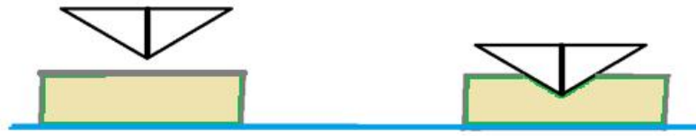
Figure IV.16 : Principe de la micro-dureté.
