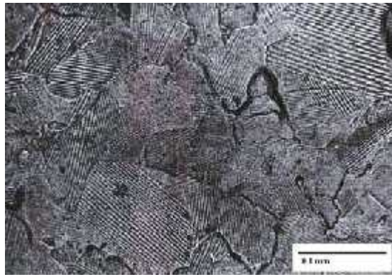
Figure II.5 : Les hydrures \epsilon par microscopie électronique à balayage [33].
