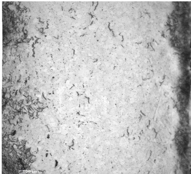
Figure V.19 : Epaisseur hydrurée ( T=300\text{ °C} , V_{ref} = 2\text{ °C/mn} ).
