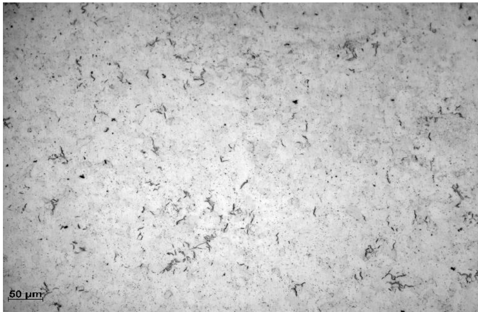
Figure V.16 : Surface hydrurée ( T=300\text{ °C} , V_{ref} = 5\text{ °C/mn} ).
