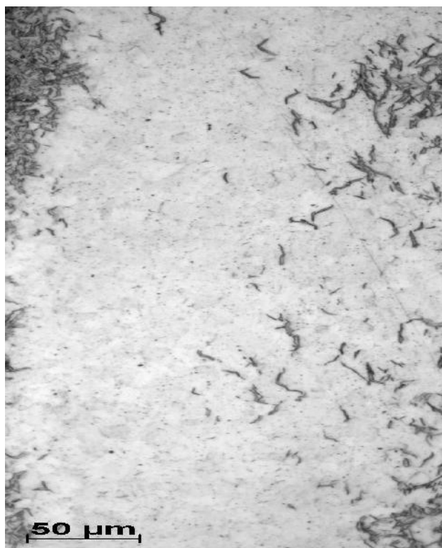
Figure V.13 : Epaisseur hydrurée ( T=300 °C, V_{ref} = 15^{\circ}\text{C/mn} ).
