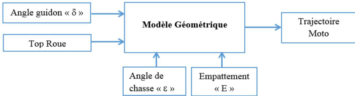
Figure 25. Schéma du modèle géométrique
