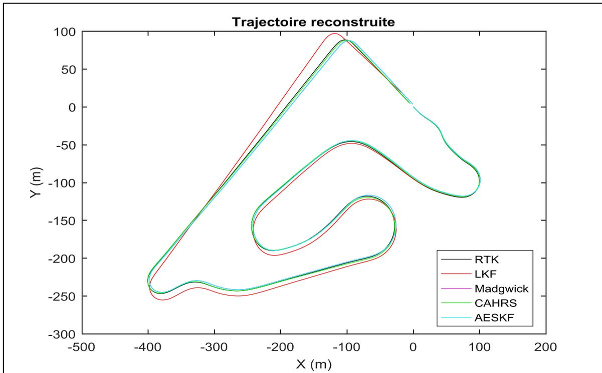
Figure 83. Résultats de la reconstruction de trajectoires d'un V2RM à l'aide de différents algorithmes d'estimation d'attitude
