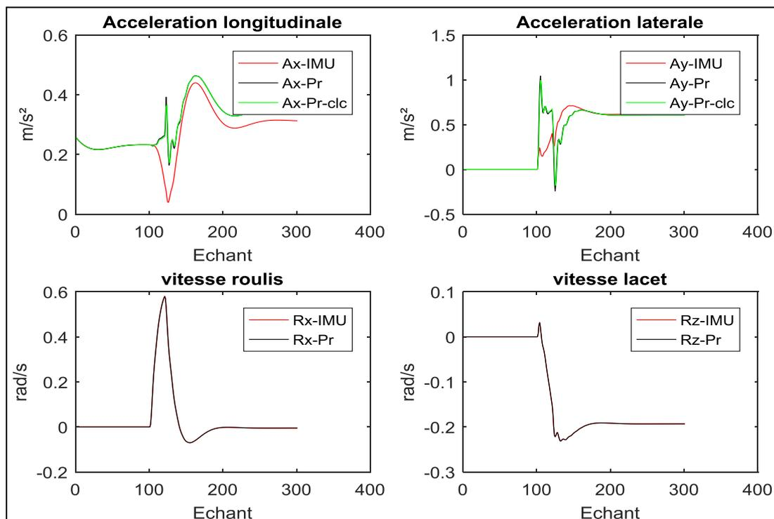
Figure 74. Données inertielles simulées et calculées
