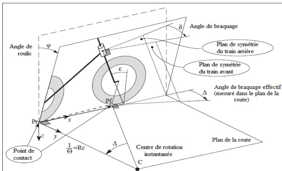
Figure 14. Configuration du véhicule dans un virage [35].
