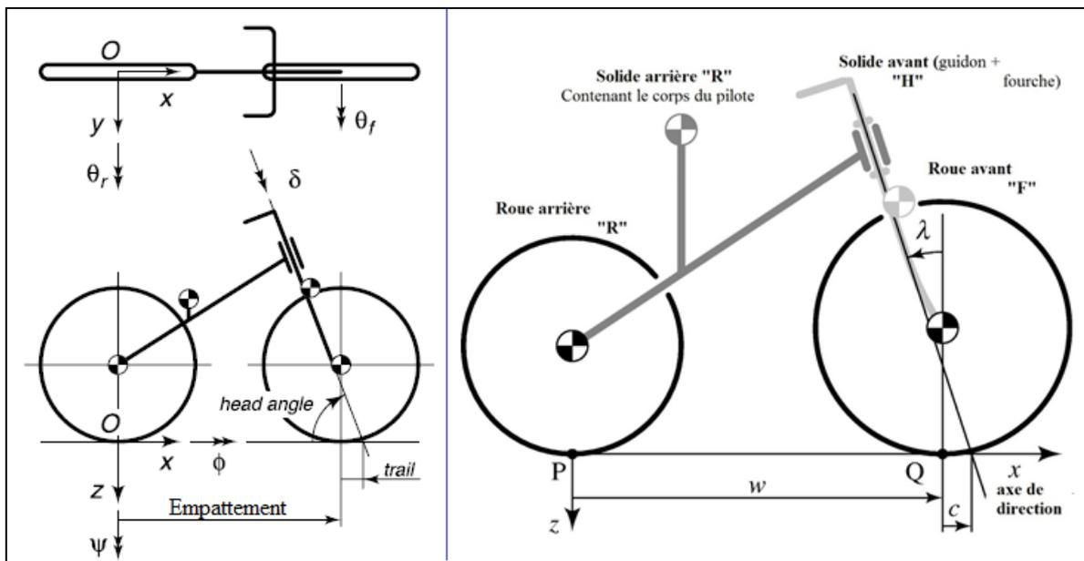
Figure 26. Les paramètres du modèle bicyclette
