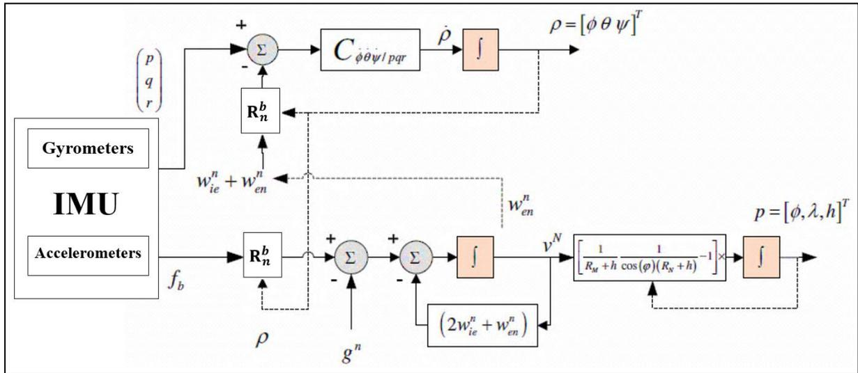
Figure 31. La mécanisation de l'INS dans le repère de navigation [14]
