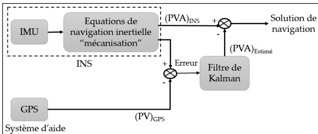
Figure 33. Mode faiblement couplé en boucle ouverte
