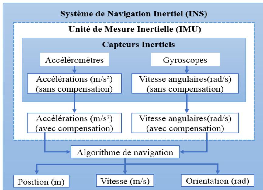
Figure 28. Fonctionnalités d'un système de navigation inertielle
