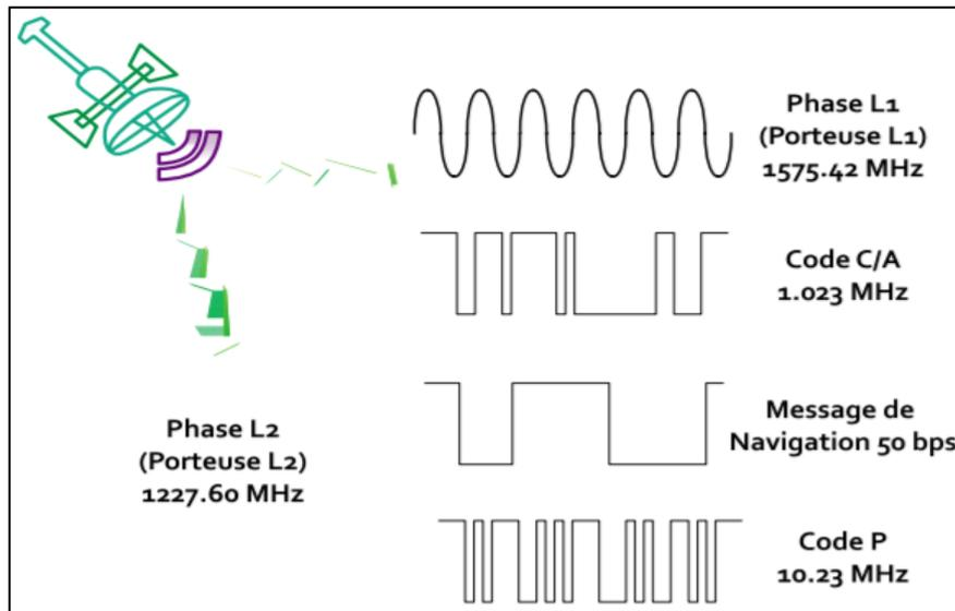
Figure 87. Structure du signal d'un satellite GPS
