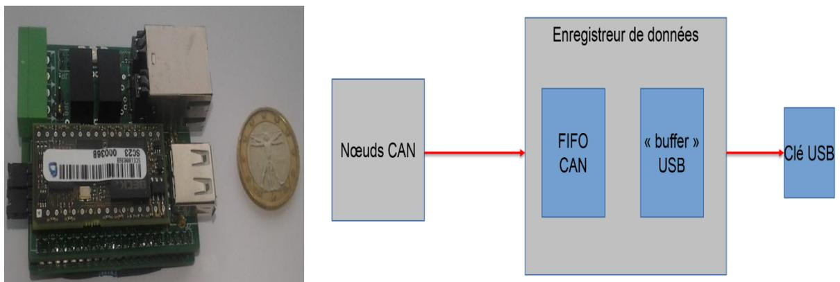
Figure 94. L'enregistreur des données et son schéma fonctionnel
