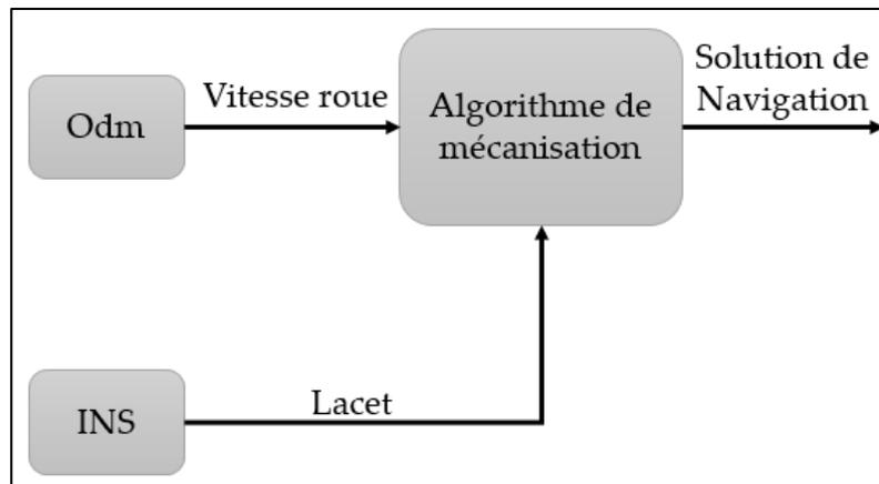
Figure 36. Schéma de la fusion des données INS/Odomètre
