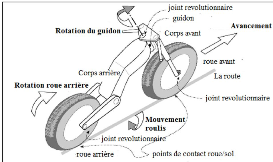
Figure 10. Structure cinématique d'un véhicule deux-roues motorisé [22]
