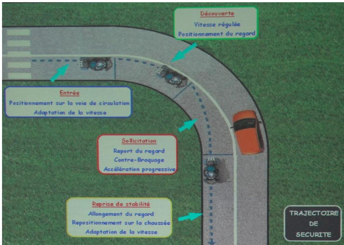
Figure 7. Topologie d'une trajectoire de sécurité [2].
