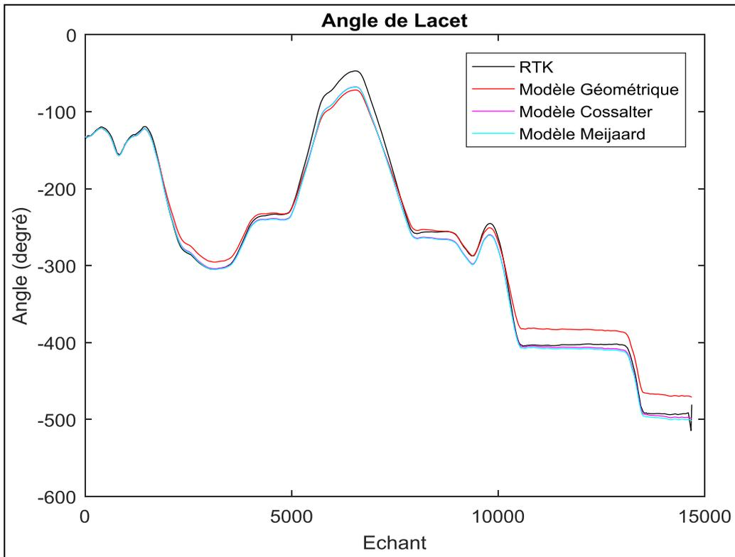
Figure 65. Angle de cap obtenu par les modèles cinématique
