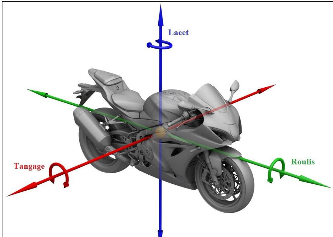
Figure 15. Les trois mouvements de rotation de la moto
