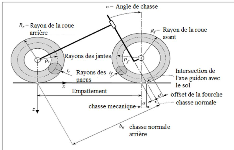
Figure 12. Géométrie d'un véhicule deux-roues motorisé [22].
