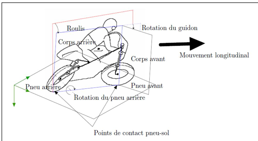
Figure 11. Les principaux mouvements d'un véhicule deux-roues motorisé.
