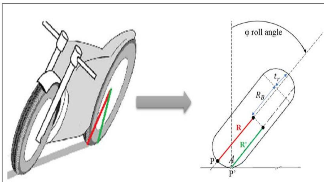
Figure 69. Déplacement latéral du point de contact de la roue arrière dans un virage
