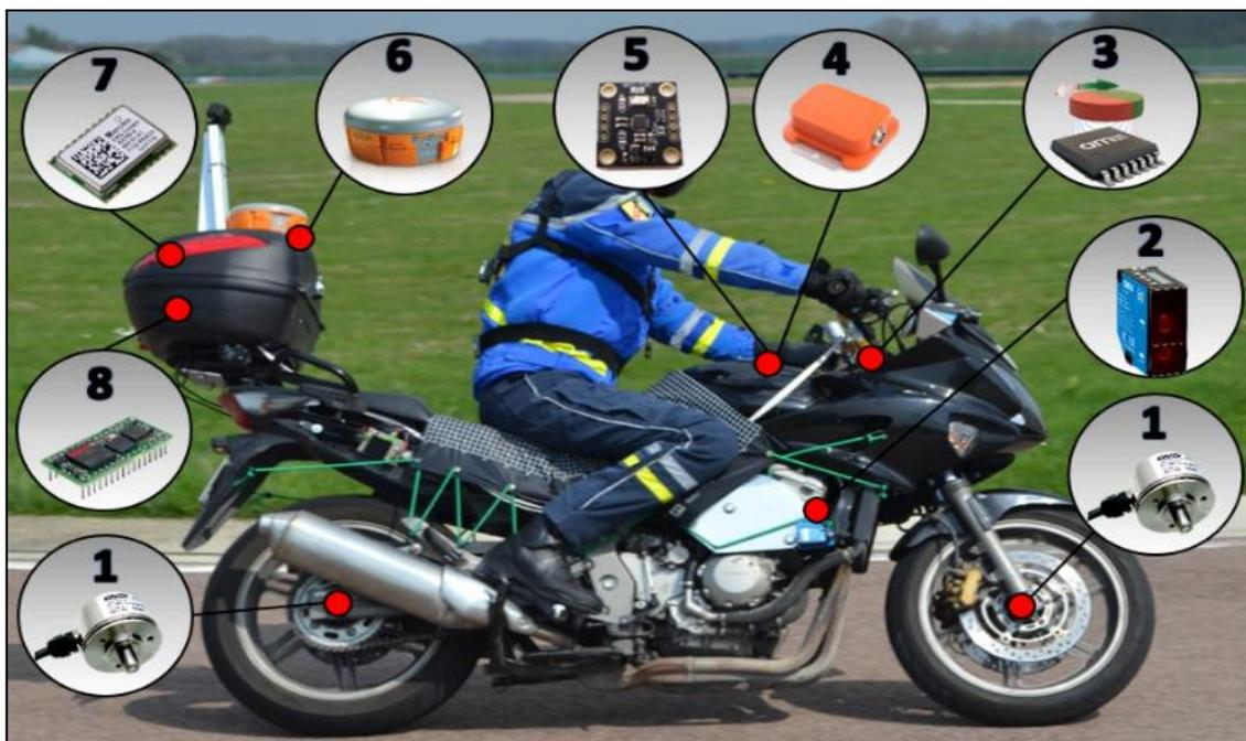
Figure 38. La moto instrumentée par l'équipe de l'ANR
