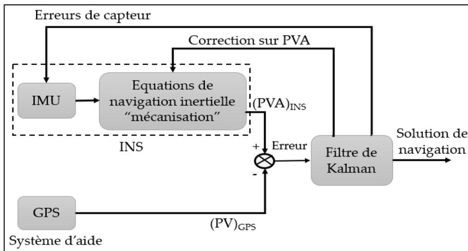
Figure 34. Mode faiblement couplé en boucle fermée
