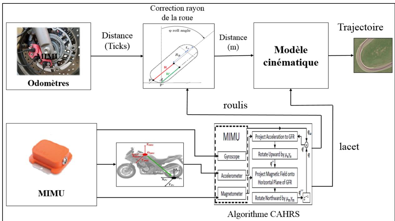
Figure 86. Schéma des modules principaux de l'algorithme final
