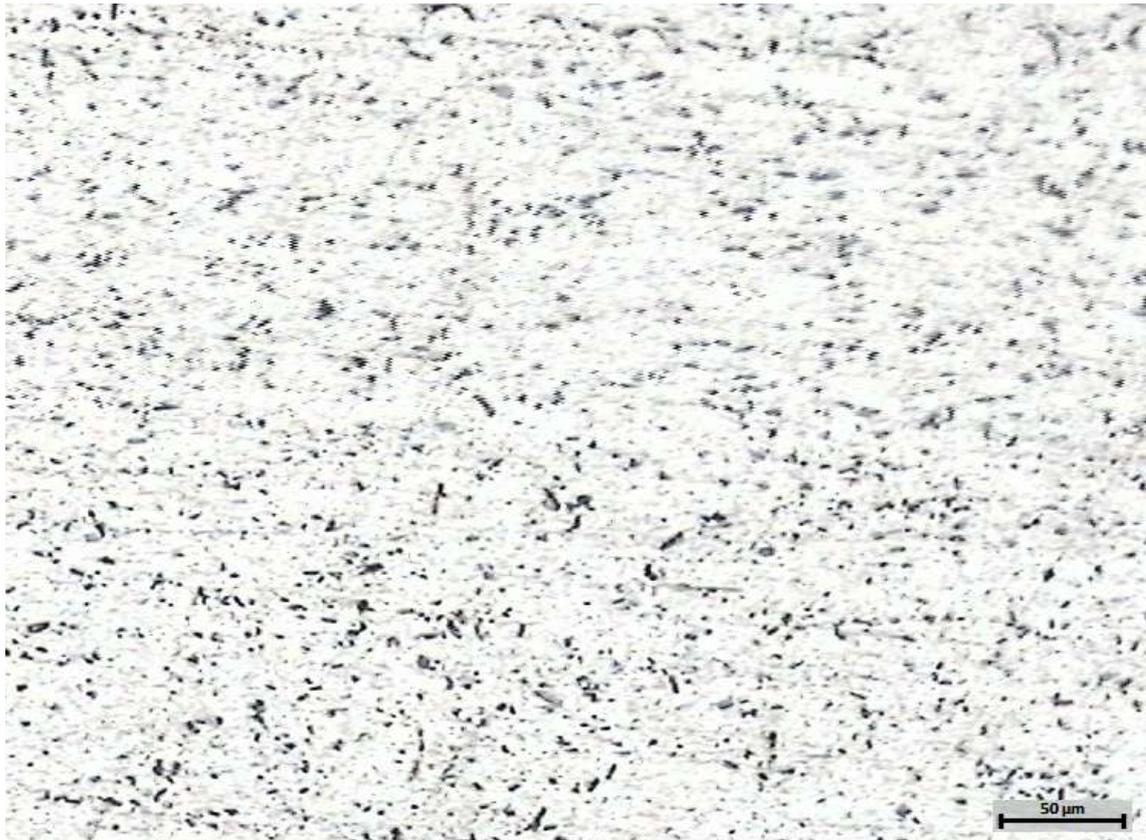
*Figure 17. Microstructure de l'alliage après 2 heures de traitements thermiques à 400 °C.*
