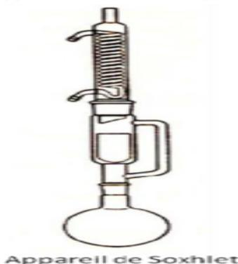
Figure IV.6 : montage d'extraction par solvant
