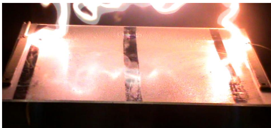
Figure IV.5 : Etapes de Contournement sur le modèle plan dans le cas d'une pollution non-uniforme ( \sigma = 1.2 \text{ mS/cm} C= 40 \text{ g/l} )
