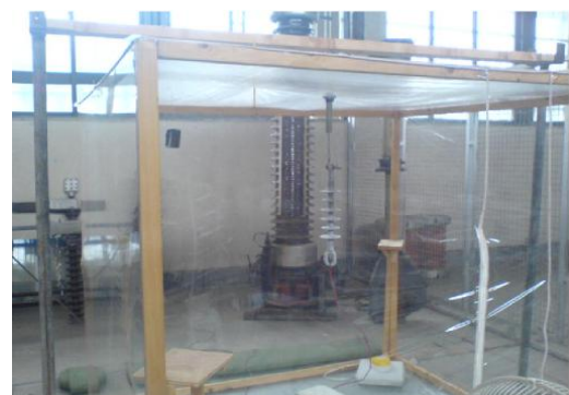
Figure I.23 : Un échantillon d'isolateur des essais sous le brouillard
