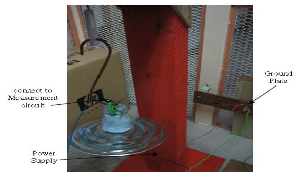
Figure I.6: Tension appliquée à la borne d'un isolateur
