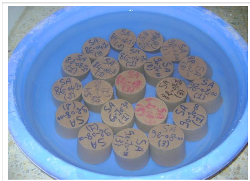
Figure 4.31. Immersion des éprouvettes
