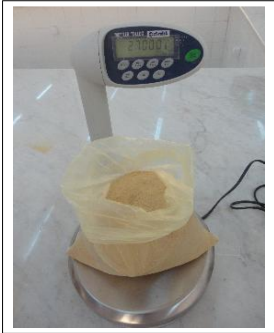
Fig.4.2. Pesée des mélanges
