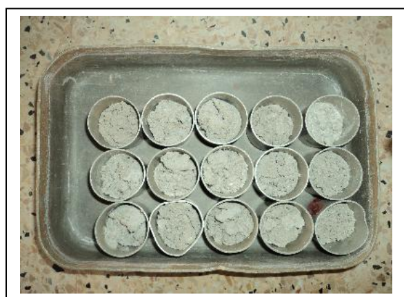
Fig.3.2.c. Echantillons après étuvage
