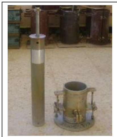
Fig.3.2.a. Moule et dame Proctor utilisés
