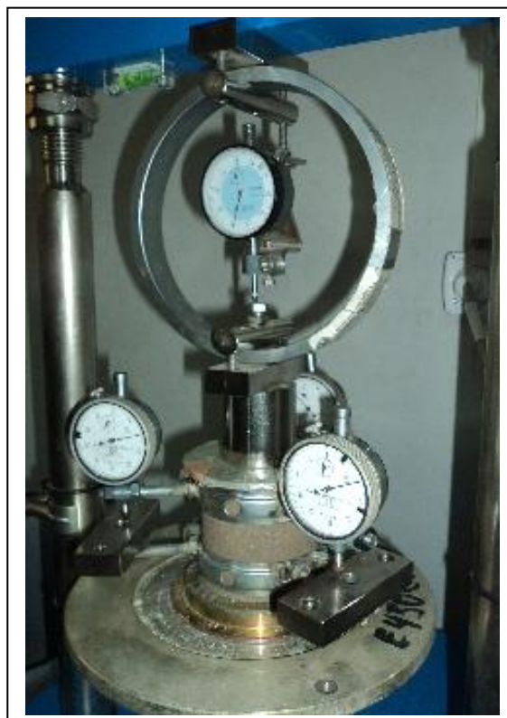
Figure 5.1. Dispositif pour la détermination du module d'élasticité Et
