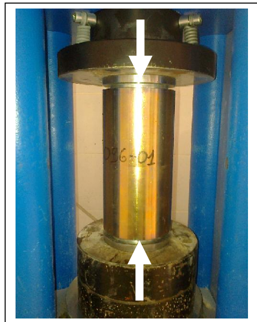
Fig4.6.b. Compactage statique des éprouvettes
