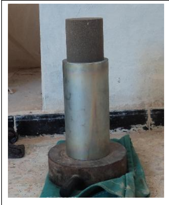
Fig. 4.7. Extraction de l'éprouvette
