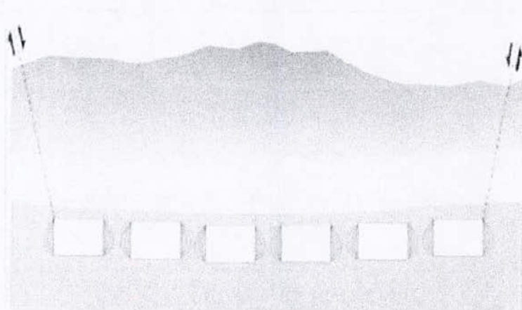
Fig.2.15. sollicitation des piliers de soutènement
