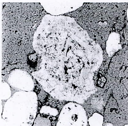
5-CHA01 : les grains de phosphate avec un ciment siliceux
