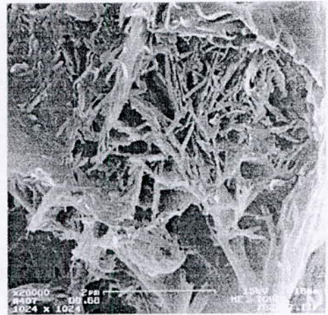
20-JB2257*20000 : les fibres constituant une forme de tube
