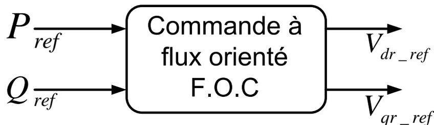
Figure 2.5 – Bloc de contrôle à flux orienté.
