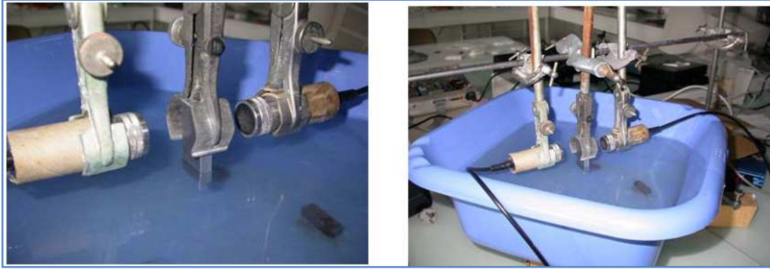
Figure IV.9 : Sondage ultra sonore par immersion [8].
