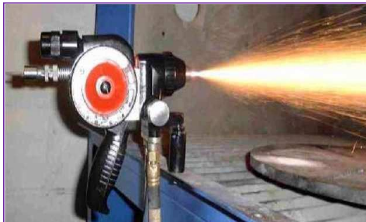
Figure I.7 : Pistolet de métallisation [6]
