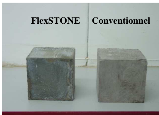
Figure 7.13 : les deux cubes Avant l'immersion dans LD2. [25]
