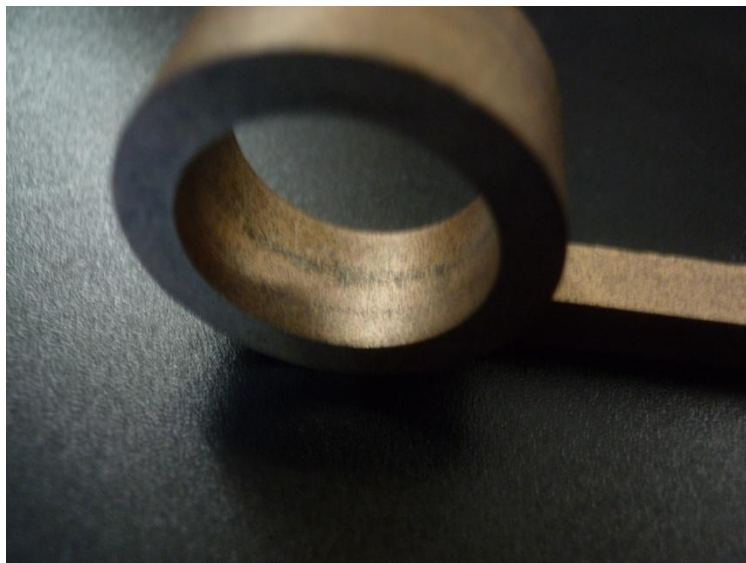
Figure VII.3 Bague présentant des stries de compactage.
