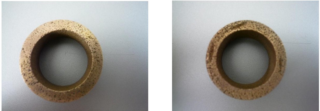
Figure VII.9 A gauche : bague polie ; A droite bague non polie.
