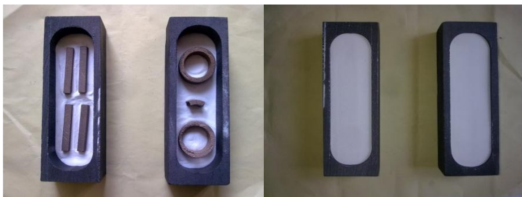
Figure VI.5 Disposition des éprouvettes dans des nacelles en graphite
