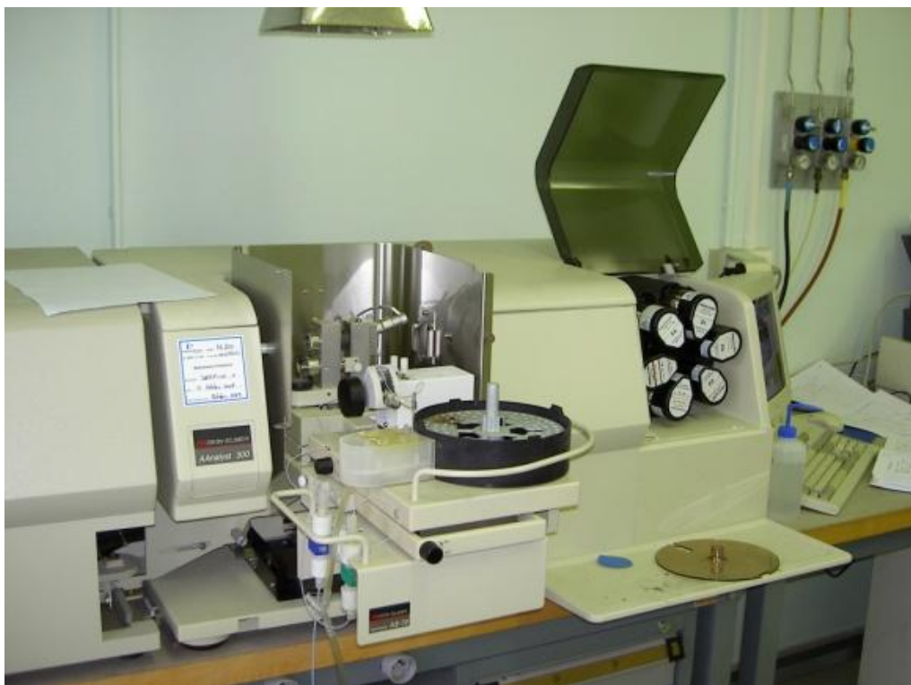
Figure V.3 Spectrophotometre d'absorption atomique.
