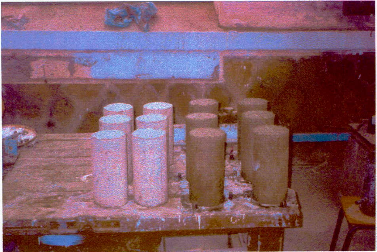
Photo 11 : 12 éprouvettes cylindriques (06 renforcées de fibres et 06 autres témoins)
