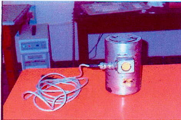
Photo 5 : Capteur inductif (CNERIB)
