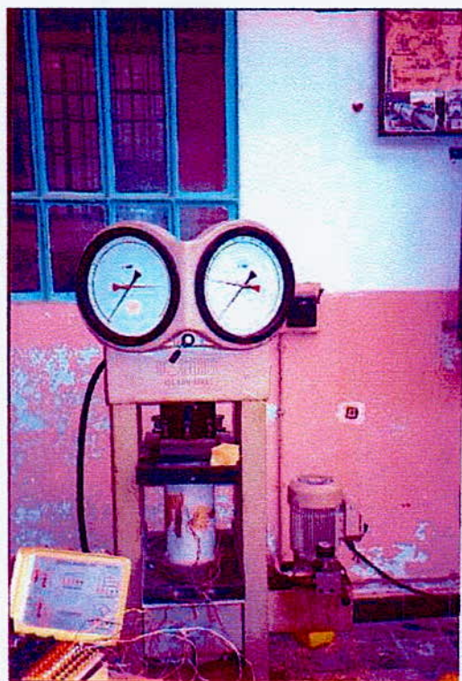
Photo 17 : Essai de compression avec lecture des déformations (ENP)
