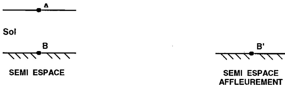
On définit la fonction de transfert comme étant le rapport reliant l'amplitude du déplacement à la surface de la couche de sol (le point A sur la figure) a l'amplitude du déplacement à l'interface (le point B), soit  $T_{1,2}$  cette fonction Nous avons, d'après la
