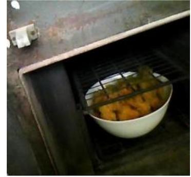
**Fig.IV.2.** Séchage dans l'étuve à 105°C
