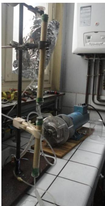
**Fig.IV.12.** Rinçage du *Luffa cylindrica* dans deux colonnes placées en série et traversées par un débit faible d'eau distillée
