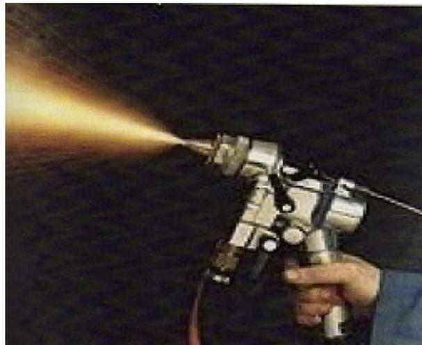
**Figure III.6 : Pistolet de projection à arc électrique "Mark61"**
