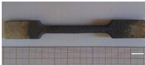
**Figure IV.6 :** *Eprouvette de traction réalisée par projection thermique*
