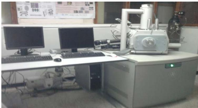
**Figure III.11 : Microscope Électronique à Balayage "QUANTA 600FEI"**
