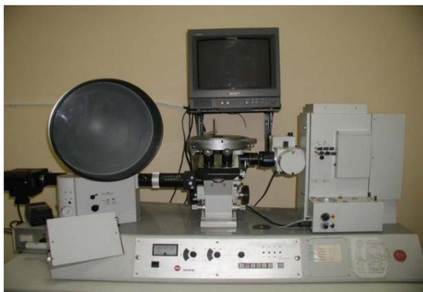
**Figure III.10 : Dispositif du microscope optique "Leitz"**
