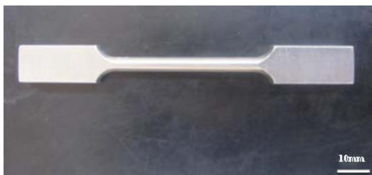
**Figure III.4.** Epreuve de traction brute.
