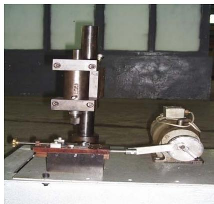
Figure III.30 : Tribomètre bille-plan [76].
