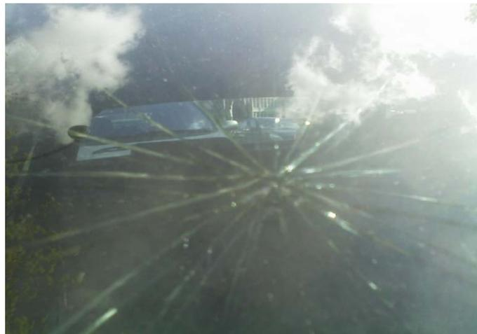
Figure II.20: Propagation de fissures sur un pare-brise.
