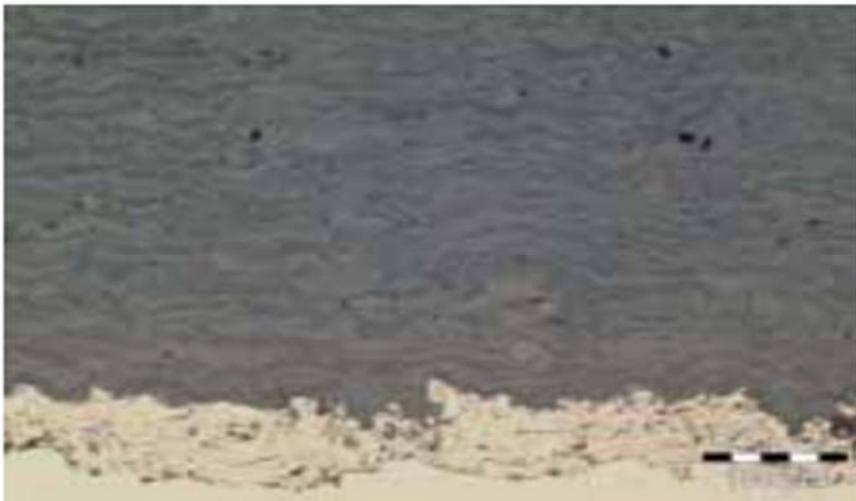
**Figure II.11.** Revêtement APS (Air Plasma Spraying) avec couche de liant Ni-Cr et couche de finition en oxyde de titane [24].
