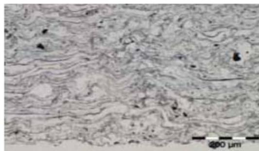
**Figure II.4.** Revêtement de métal après projection à l'arc électrique [25]
