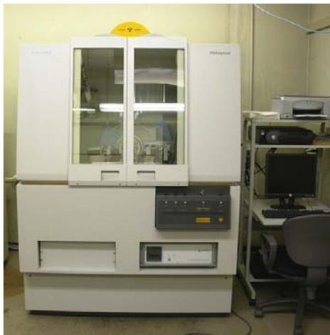
**Figure III.9 : Diffractomètre de type "X'PERT-PRO"**
