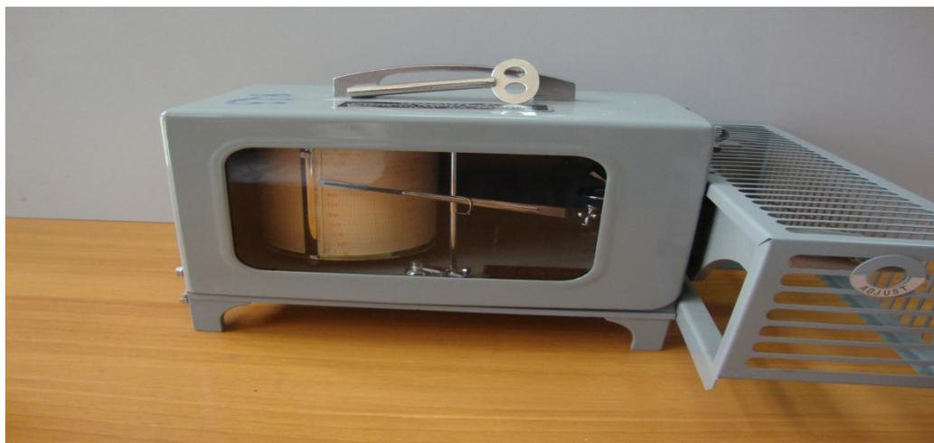
**Figure IV.15: hygromètre pour la mesure de l'humidité extérieure**
