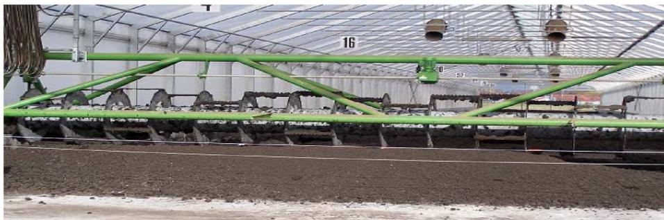
**Figure II.6 Rouleau scarificateur du système IST [4]**
