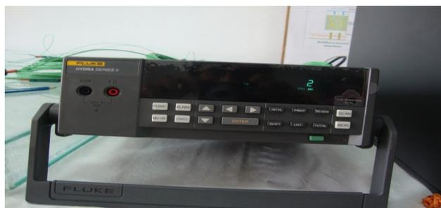
**Figure IV.6: système d'acquisition de données pour la température (FLUKE)**
