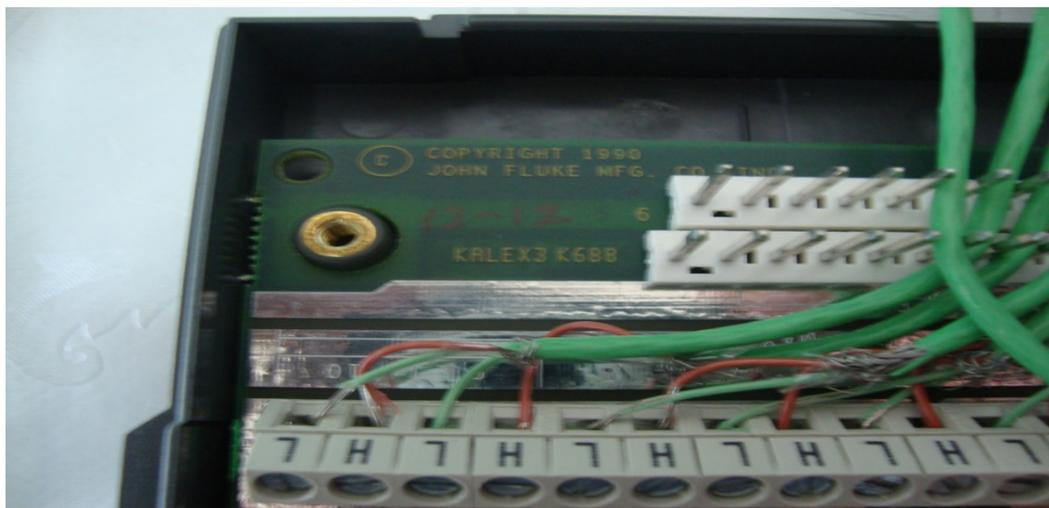
**Figure IV.11: branchement des thermocouples avec le FLUKE**
