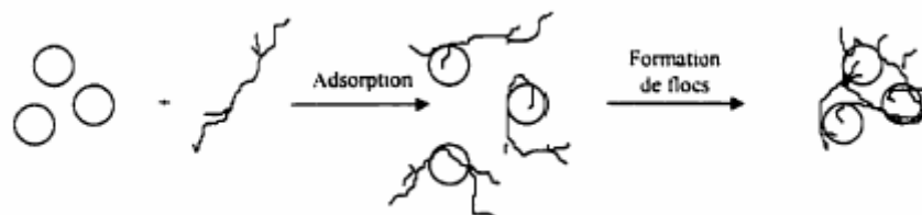
Figure 4 : Adsorption et pontage à l'aide de polymères [8]
