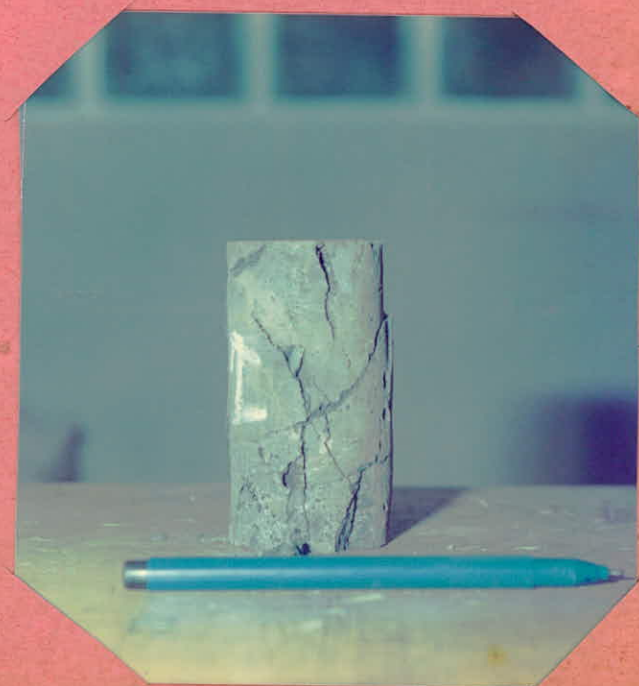
→ Eprouvette de minerai de fer après essai .
