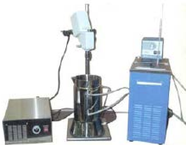
Figure 12 : Système d'extraction sous ultrasons avec contrôle de température du réacteur
