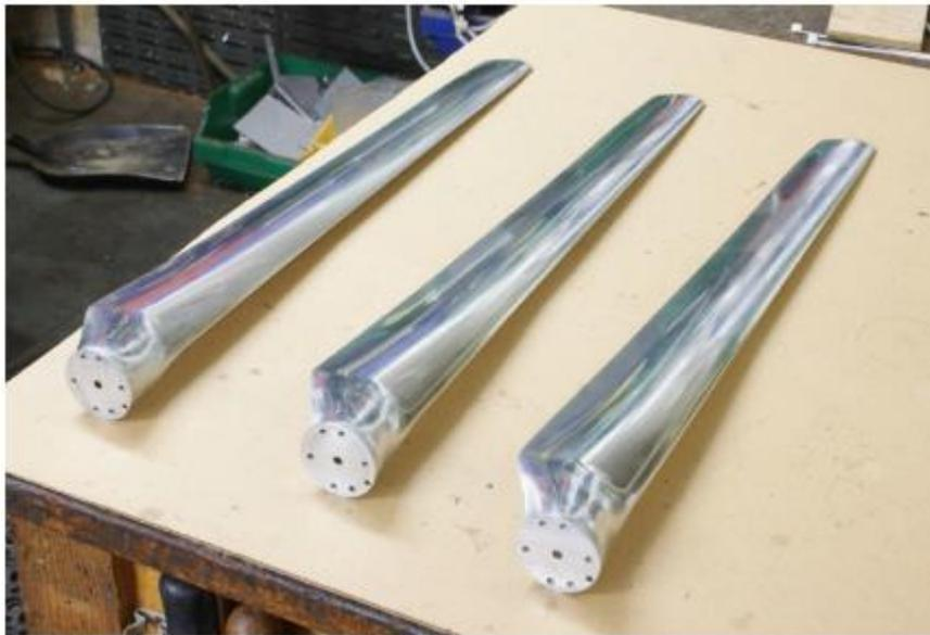
*Figure III.13 : Pales après l'usinage complet.*
