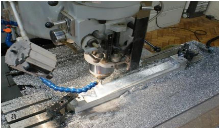
*Figure III.11 : Usinage du premier côté par la machine CNC.*
