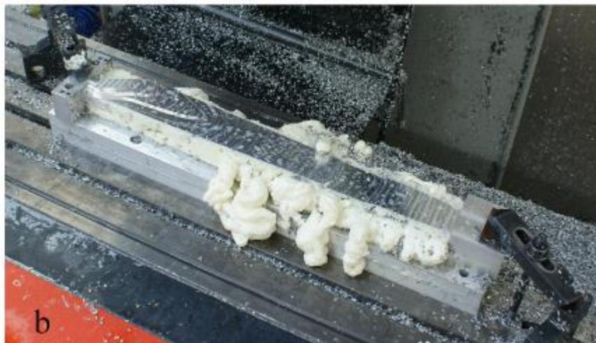
*Figure III.12 : La configuration pour l'usinage du deuxième côté avec l'emballage en mousse.*
