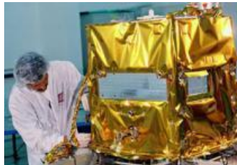
Figure I.11. Photo montrant la pose du Milor (revêtement thermique du satellite).
