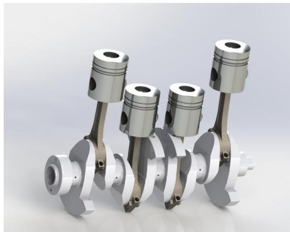
Figure II.4. Conception de l'attelage mobile sous Solidworks
