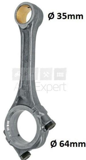
Figure I.5. Bielle du moteur F4L912.
