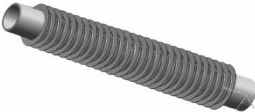
**Fig. II.9.b.** Modèle Unigraphics 3-D de l'isolateur [2]
