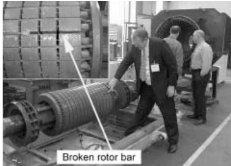
Fig. II.8 Représentation des cassures des barres rotoriques.
