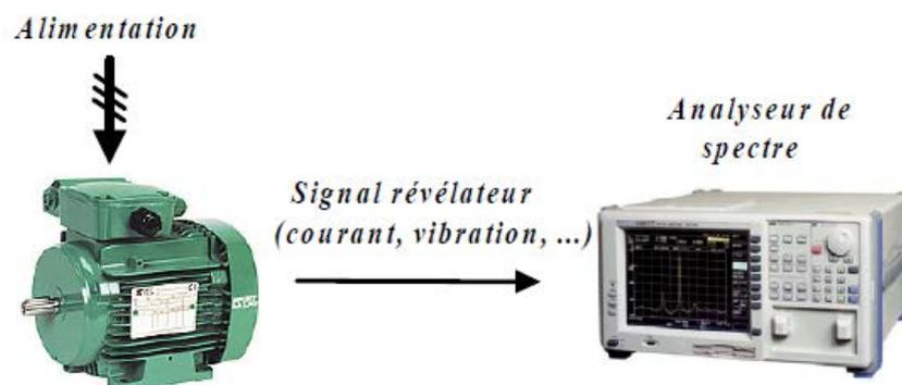
Fig. I.5: Principe de la surveillance par analyse spectrale [20]
