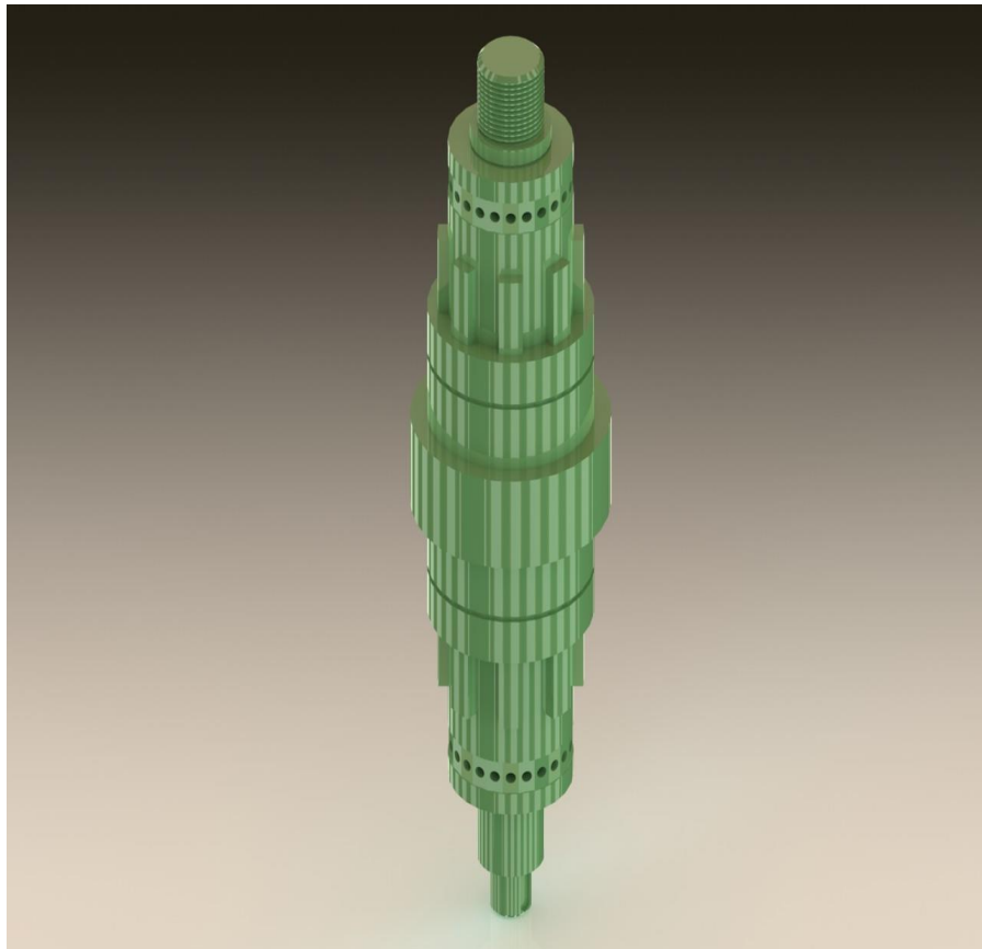
Fig. 1.7 – Arbre du vibreur conçu sous Solidworks. [BEN_2015].
