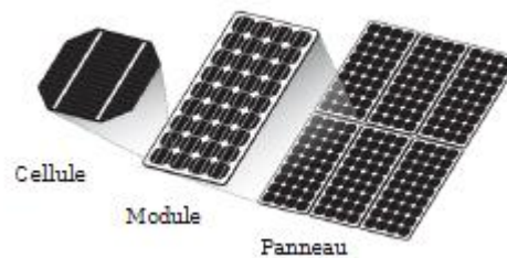
Figure 1.2 Composants d'un générateur photovoltaïque.
