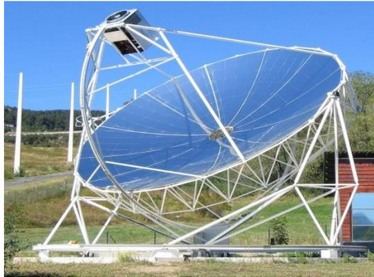
Figure 1.1 Capteur solaire sphérique
