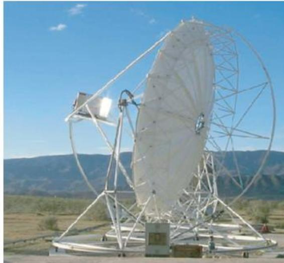
Figure 1.2 Prototype préindustriel Eurodish, 10 kWe, construit par SBP-SOLO (Allemagne)
