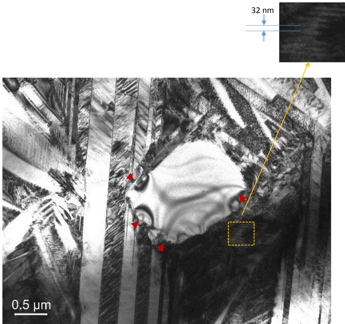
Figure 43: Micrographie électronique MET montrant un précipité en interaction avec les plaquettes de martensite (indiqués par des flèches rouges), et le zoom d'une série de clivages formés dans la matrice martensitique (cadre orange).
