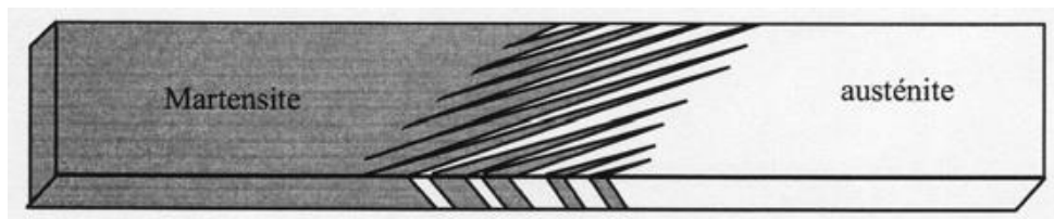
Figure 9: Front de transformation dans un monocristal Cu-Zn-Ga [SAB76].
