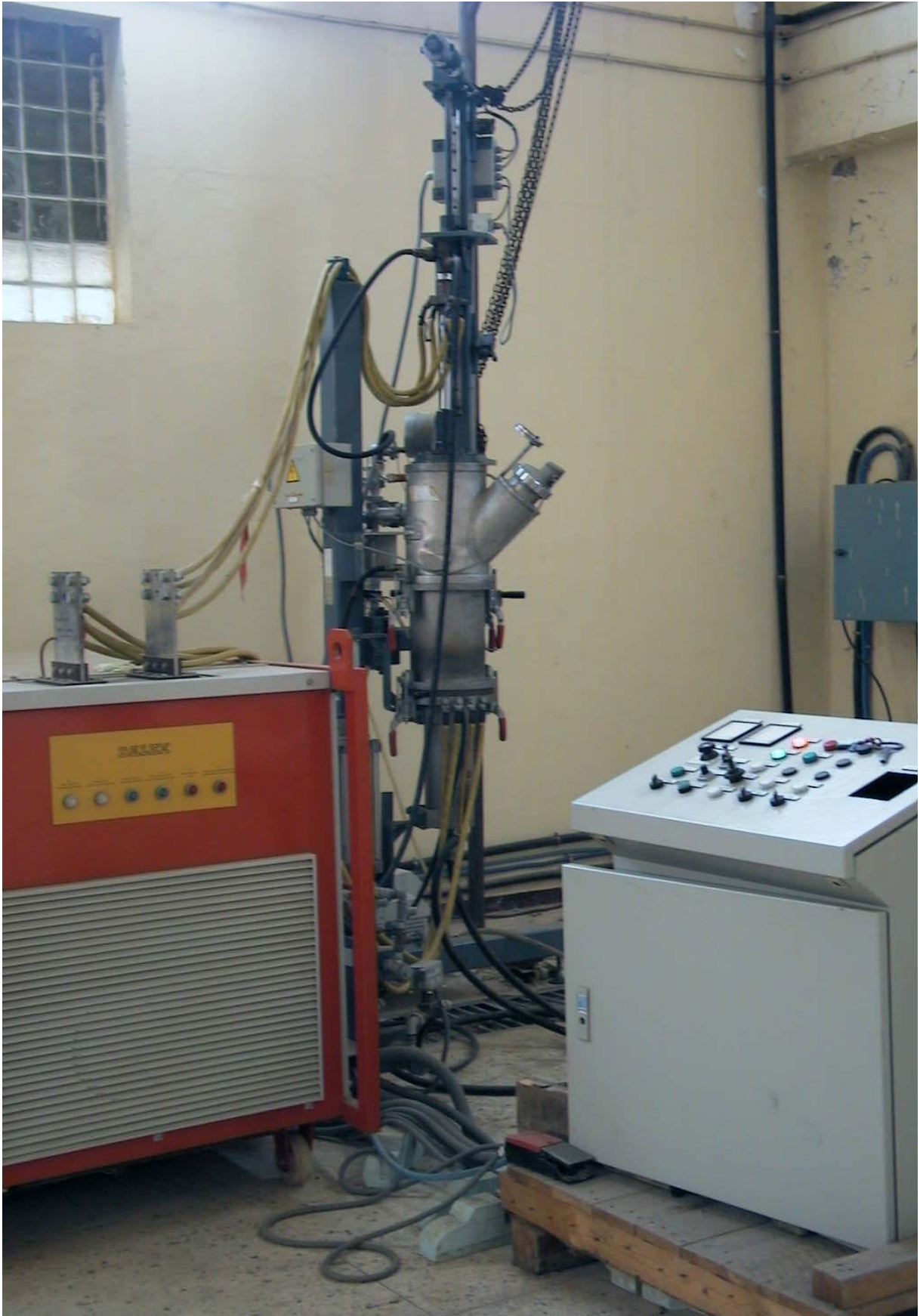
Figure III - 01 : Représentation du four à arc avec l'option « électrode consommable »
