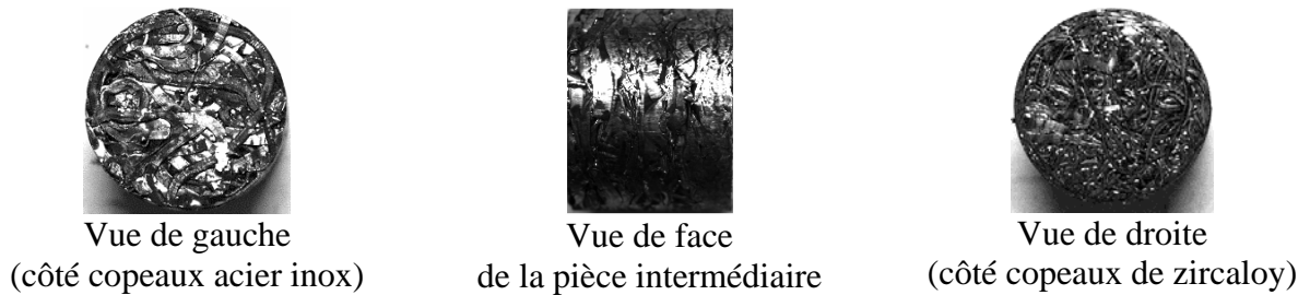
Figure IV - 13 : pièce intermédiaire à partir du compactage de copeaux Diamètre et hauteur de la pièce égales à 20 mm
