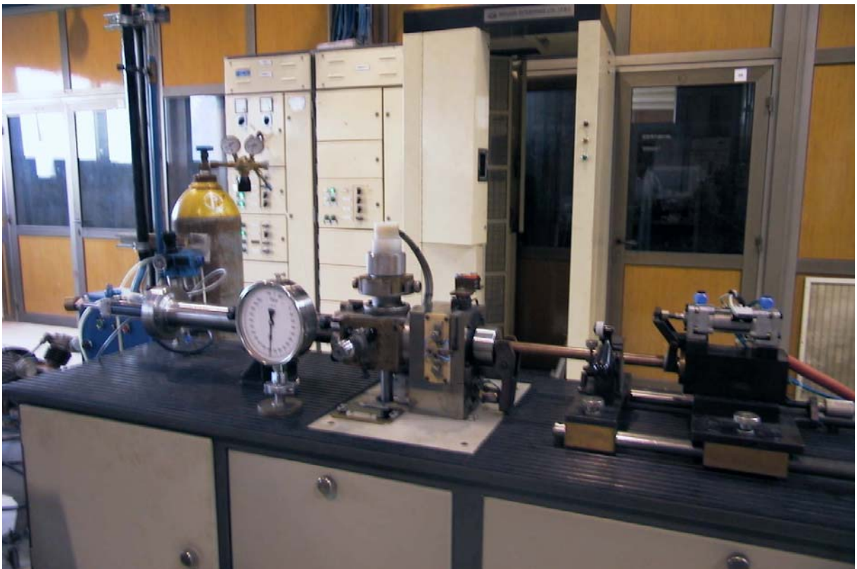
Figure IV – 07 : Photo de l'équipement de soudage radial des compacts
