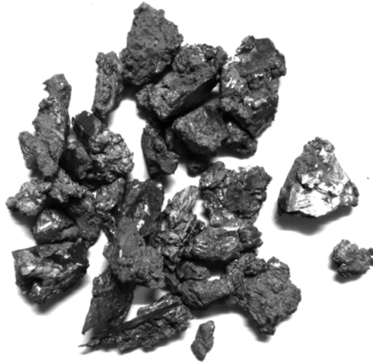
Figure IV - 04 : Photo de l'éponge de zirconium (G=1)
