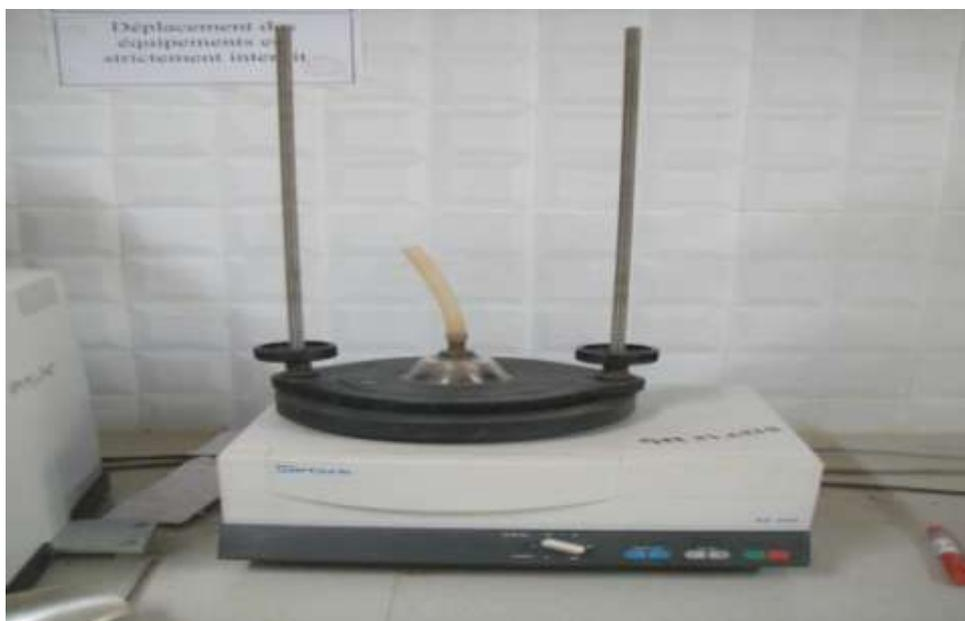
**Figure 2.2** : Tamiseuse électrique de type Retsch- AS 20
