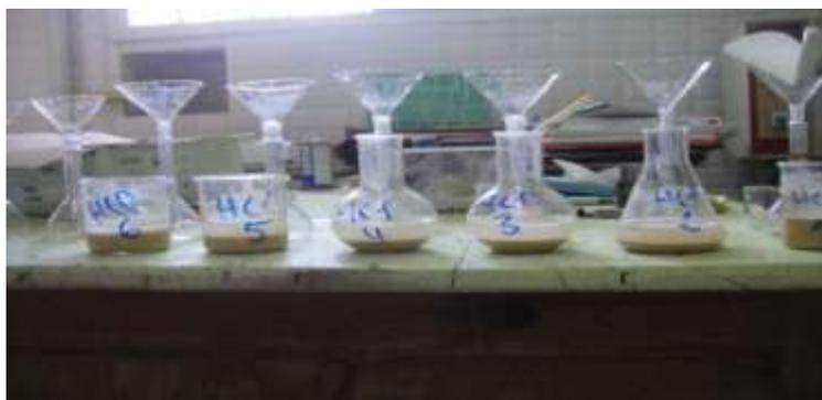
**Figure 2.6 :** Attaque chimique par acide HCl des échantillons de kaolin
