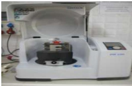
**Figure 2.1** : Broyeur à billes de type Retsch - PM 100
