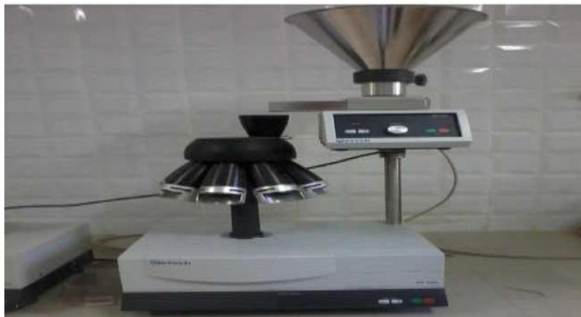
**Figure 2.3 :**Échantillonneur automatique de type Retsch- PT 100
