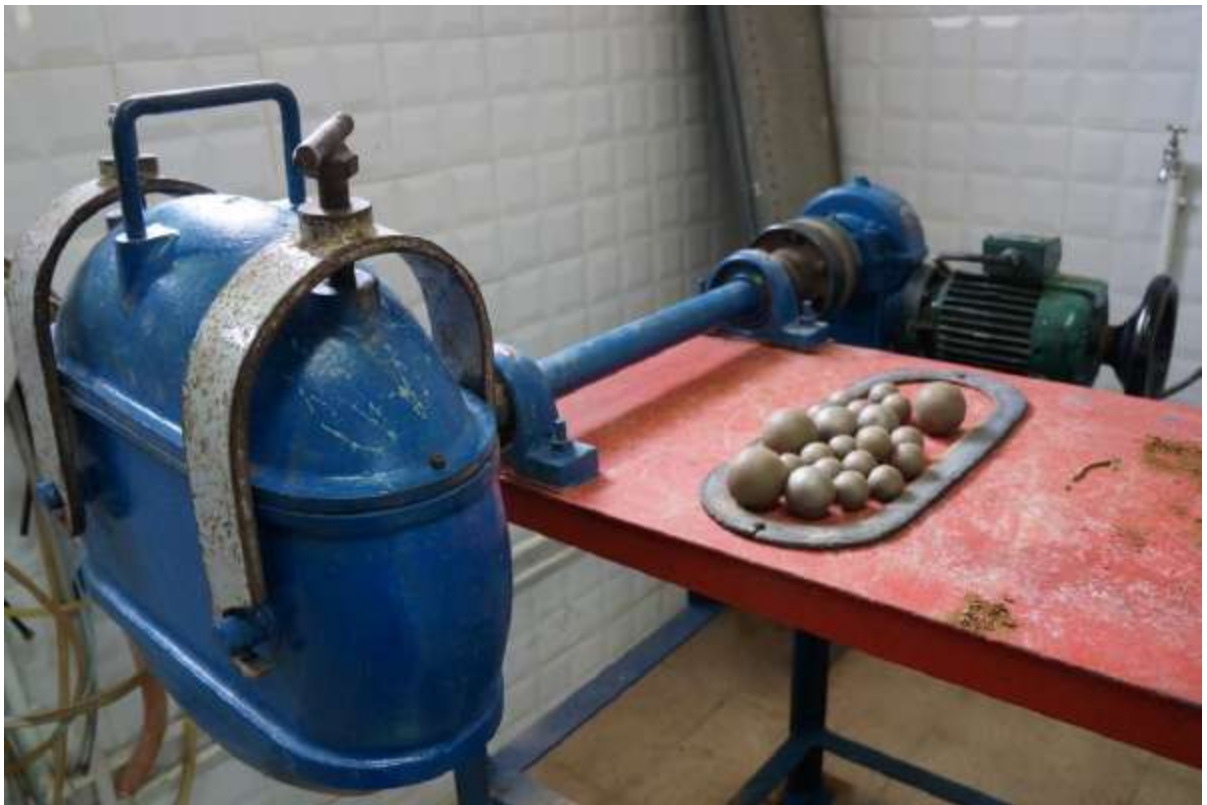
Figure III.4 : Broyeur à boulets
