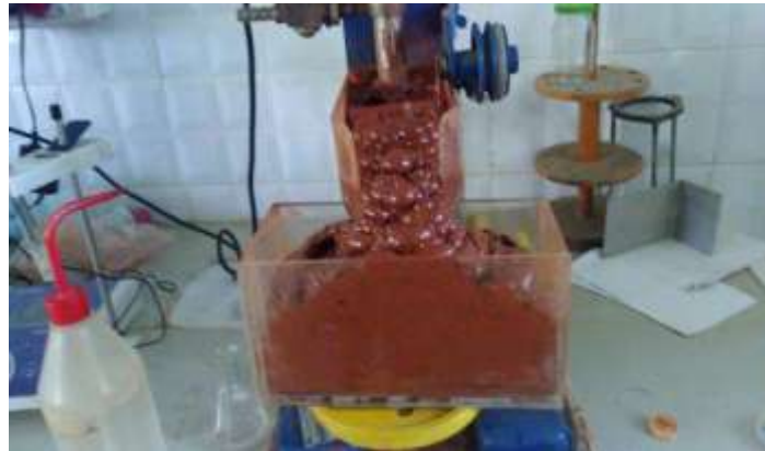
Figure III.8 : Mousse récupérée après l’essai de flottation
