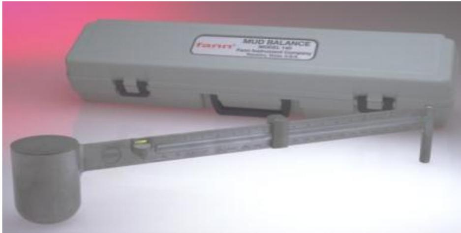
Figure 3 Densimètre des boues de forage
