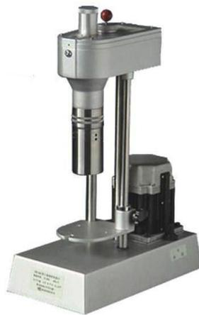
Figure 5 : Viscosimètre à cylindre Fann
