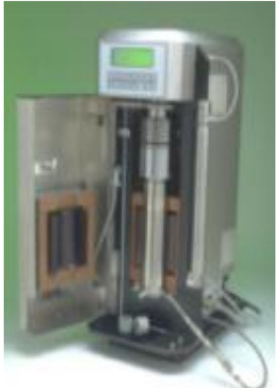
Figure 2 : appareil de filtration des boues de forage
