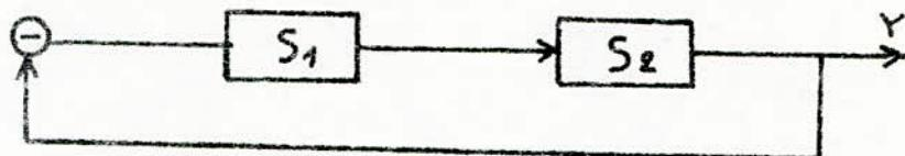
la cascade ( $S_1 S_2$ ) (système en boucle ouverte) pouvant représenter des parties non gouvernables et (ou) non observables, son équation d'état peut être mise sous la forme canonique de Kalman.
