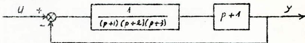
les équations d'état du système ( $S_1 S_2$ ) en cascade (boucle ouverte)
