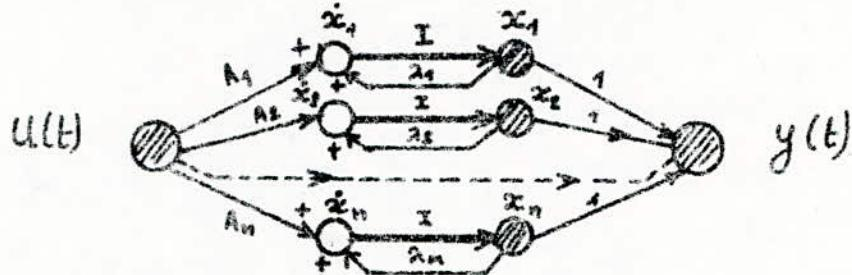
$$(6) \quad \begin{bmatrix} \dot{x}_1 \\ \dot{x}_2 \\ \vdots \\ \dot{x}_n \end{bmatrix} = \begin{bmatrix} \lambda_1 & 0 & \cdots & 0 \\ 0 & \lambda_2 & \cdots & 0 \\ \vdots & \vdots & \ddots & \vdots \\ 0 & 0 & \cdots & \lambda_n \end{bmatrix} \begin{bmatrix} x_1 \\ x_2 \\ \vdots \\ x_n \end{bmatrix} + \begin{bmatrix} A_1 \\ A_2 \\ \vdots \\ A_n \end{bmatrix} u(t)$$
