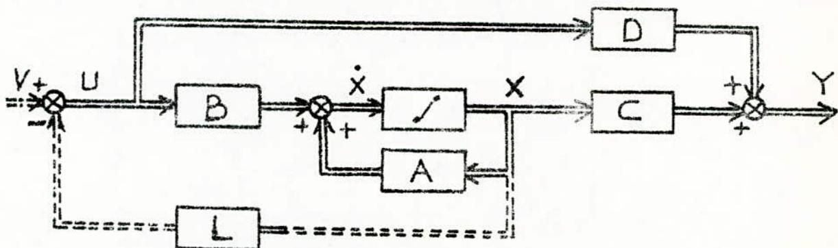
on montre que si le système (1) est commandable par  $U$ , le système (2) est toujours commandable par  $V$  quelque soit  $L$ , mais peut quelque fois ne pas être observable.
