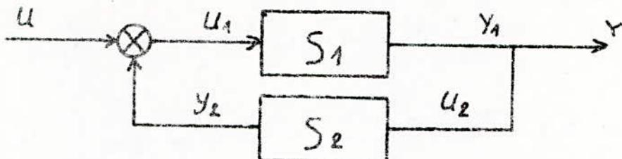
Le système est gouvernable si et seulement si la cascade  $(S_1, S_2)$  est gouvernable (entrée  $U_1$ ; sortie  $Y_1$ ).
