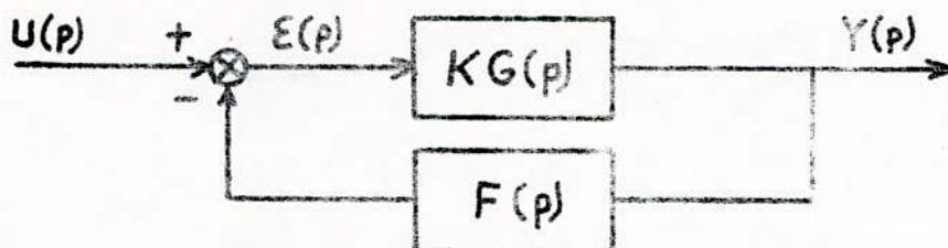
Pour étudier la stabilité de ce système par cette méthode, on doit étudier la fonction de transfert en boucle ouverte. La fonction de transfert de ce système en boucle ouverte est:  $H_o(p) = KG(p) \cdot F(p)$
