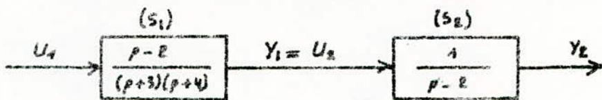
D'après la décomposition de la fonction de transfert  $F(p)$  de ( $S_1$ ) le bloc synaptique du système en cascade ( $S_1, S_2$ ) deviendra :
