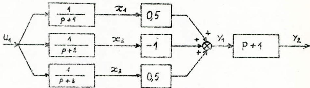
$$\begin{cases} y_1 = 0.5x_1 - x_2 + 0.5x_3 \\ y_2 = y_1 + y_3 \\ y_3 = 0.5x_1 - x_2 + 0.5x_3 + 0.5x_1 - x_2 + 0.5x_3 \end{cases} \Rightarrow \begin{cases} \dot{x}_1 = -x_1 + u_1 \\ \dot{x}_2 = -x_2 + 2u_1 \\ \dot{x}_3 = -x_3 + 3u_1 \end{cases}$$
