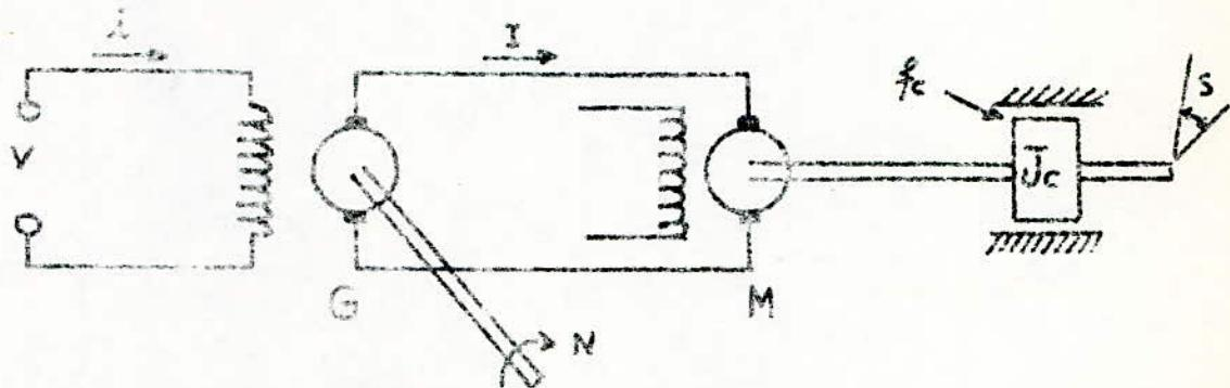
Ce dispositif sert à commander la position angulaire  $s$  d'un arbre qui entraîne une charge d'inertie  $J_c$ . Cet organe se compose d'une génératrice continue -G- et d'un moteur M continu placés en cascade.
