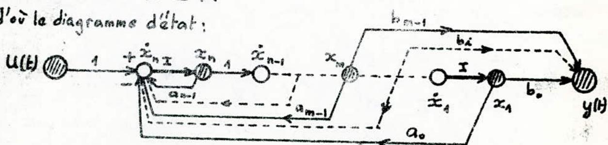
EXEMPLE soit le système:  $\ddot{y} + 3\dot{y} + 4y = 2\ddot{u} + 5\dot{u} + 7u$
