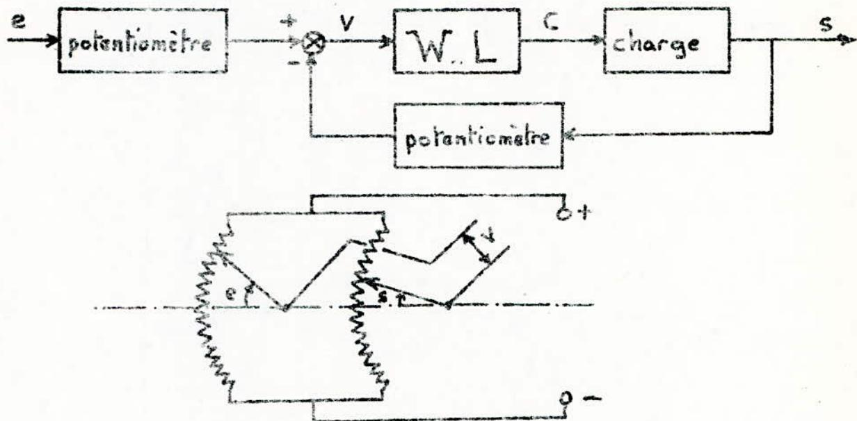
Des deux équations précédentes on déduit par élimination des variables intermédiaires  $V$ ,  $I$  et  $C$  la relation entre l'entrée et la sortie  $s$ .
