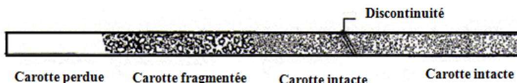
FIGURE II.3 – Description d'un carottage
