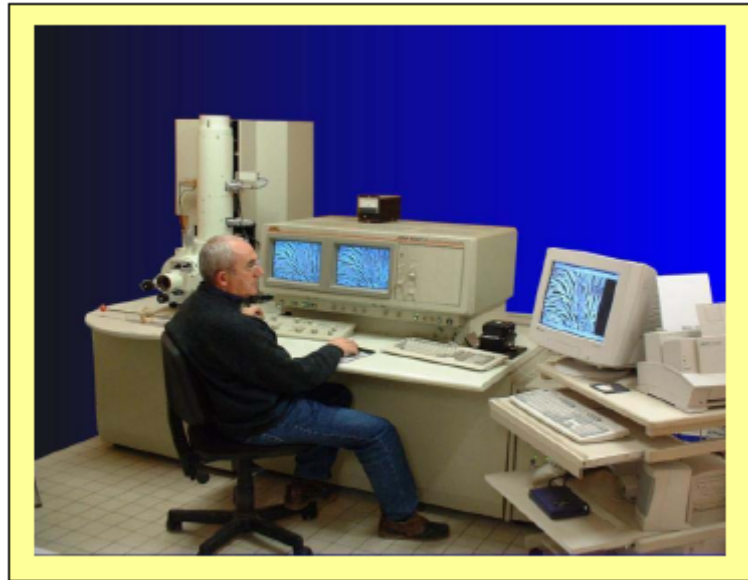
Fig. VII-6 – Microscope électronique à balayage Jeol (JSM 6301F).
