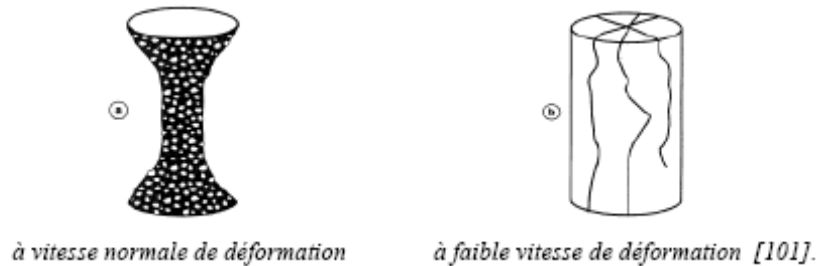
Fig. IV-3 – Rupture des BHP testés
