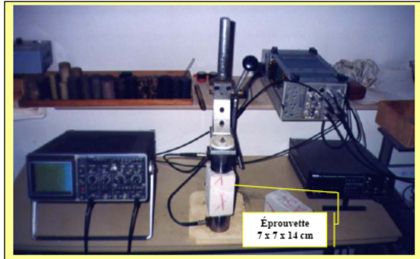
Fig. IX-5 – Appareil de mesure de la vitesse longitudinale du son.
