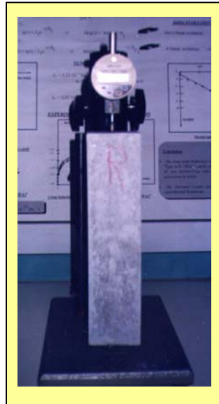
Fig. IX-23 – Essai de retrait.
