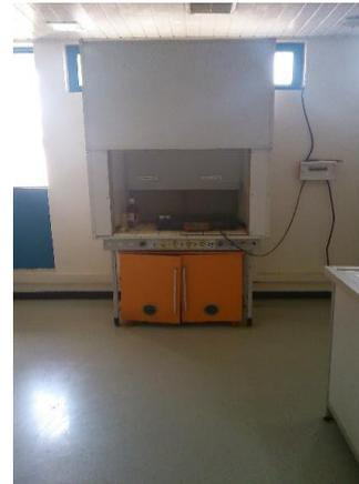
Figure 13: chauffage des échantillons attaqués par l'eau régale
