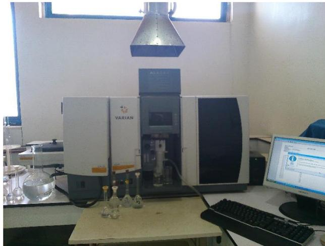
Figure 15 : spectromètre d'absorption atomique à flamme
