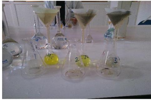
Figure 14: filtrage après l'attaque par les acides
