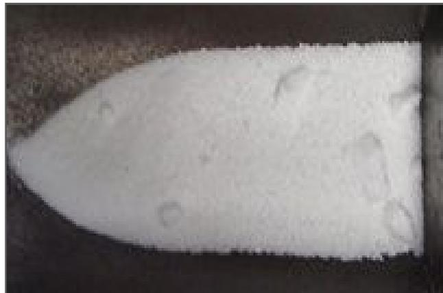
**Fig. II. 18** :« Flux- Borax » poudre fine blanche utilisée pour éviter l'oxydation et aider à l'infiltration
