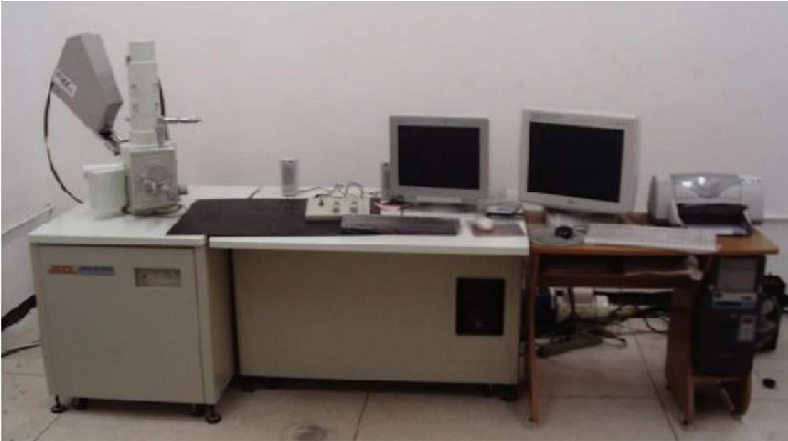
**Fig. II.** Microscope électronique à balayage JEOL JSM 6830 (photo LSGM).
