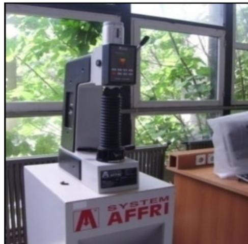
Fig.II.20: Machine de la dureté « Duromètre »
