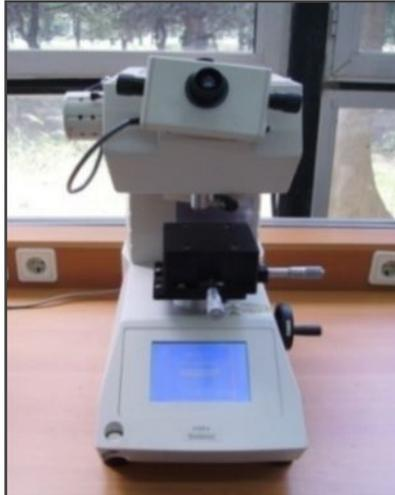
**Fig. II.21:** Machine de la microduromètre.
