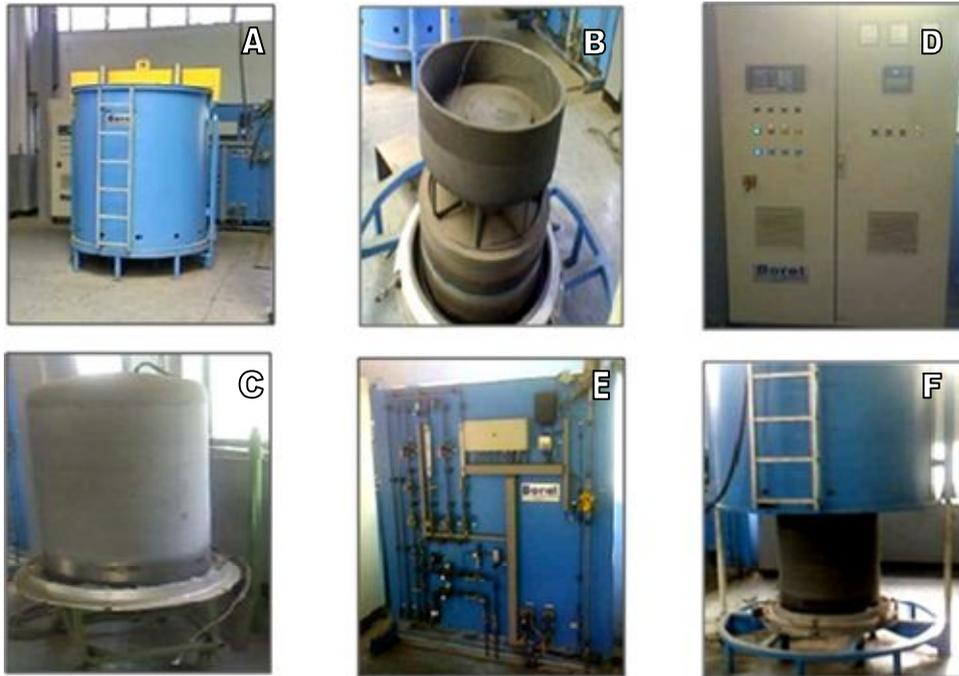
**Fig. II. 17 :** Four à hydrogène et son installation : (A) vue d'ensemble de l'installation, (B) base de chargement, (C) cloche mobile, (D) Armoire de commande, (E) panneaux des gaz, (F) la mise du four sur la cloche fermé [72].
